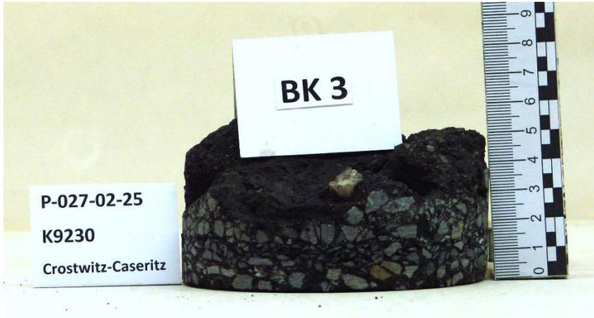
Fahrbahnoberkante im Foto an der Unterseite des Bohrkerns (Bohrkern steht auf dem Kopf!)
