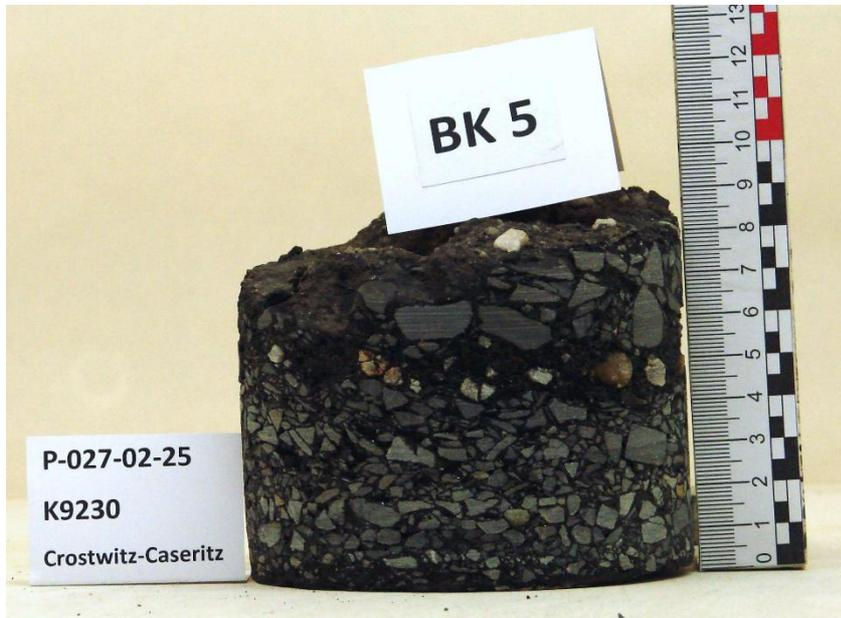
Fahrbahnoberkante im Foto an der Unterseite des Bohrkerns (Bohrkern steht auf dem Kopf!)
