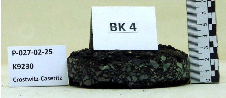
Fahrhahnoberkante im Foto an der Unterseite des Bohrkerns (Bohrkern steht auf dem Kopf!)
