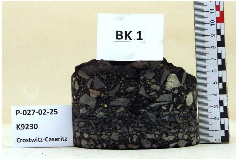
Fahrbahnoberkante im Foto an der Unterseite des Bohrkerns (Bohrkern steht auf dem Kopf!)
