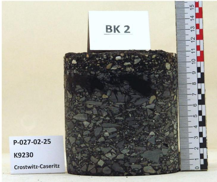
Fahrbahnoberkante im Foto an der Unterseite des Bohrkerns (Bohrkern steht auf dem Kopf!)
