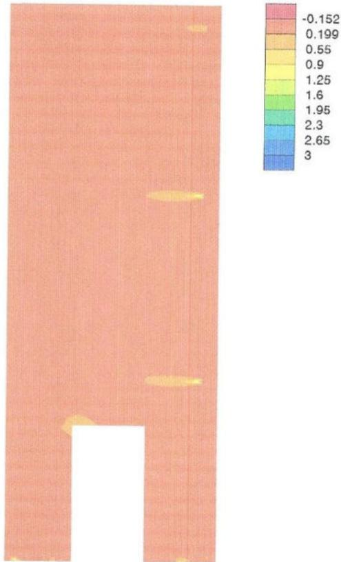
Normalspannungen  $\sigma_{yy,min}$  [N/mm<sup>2</sup>]
