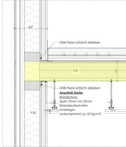
Vertikalschnitt Geschosdecke an AW Schallschutz + Brandschutz
