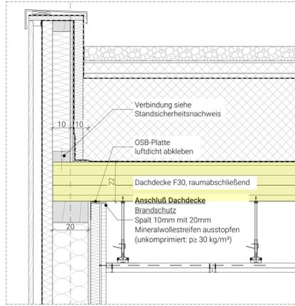
Vertikalschnitt Geschosdecke an Attika Schallschutz + Brandschutz
