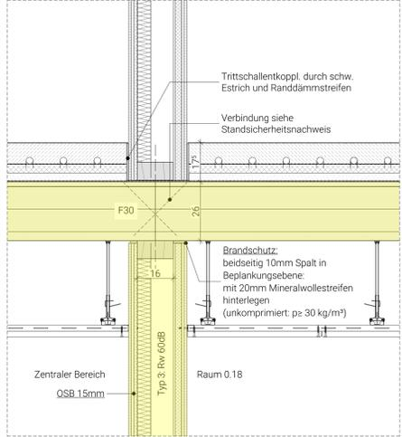
Vertikalschnitt Innenwand an Decke Schallschutz + Brandschutz
