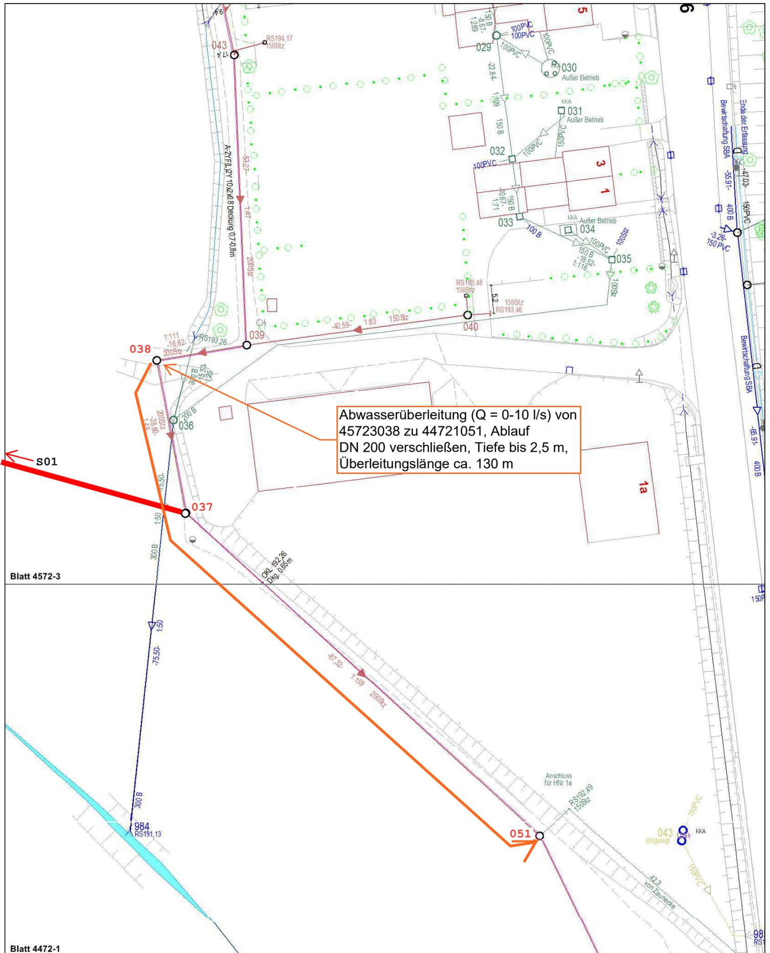
Abwasserüberleitung (Q = 0-10 l/s) von 45723038 zu 44721051, Ablauf DN 200 verschließen, Tiefe bis 2,5 m, Überleitungslänge ca. 130 m
