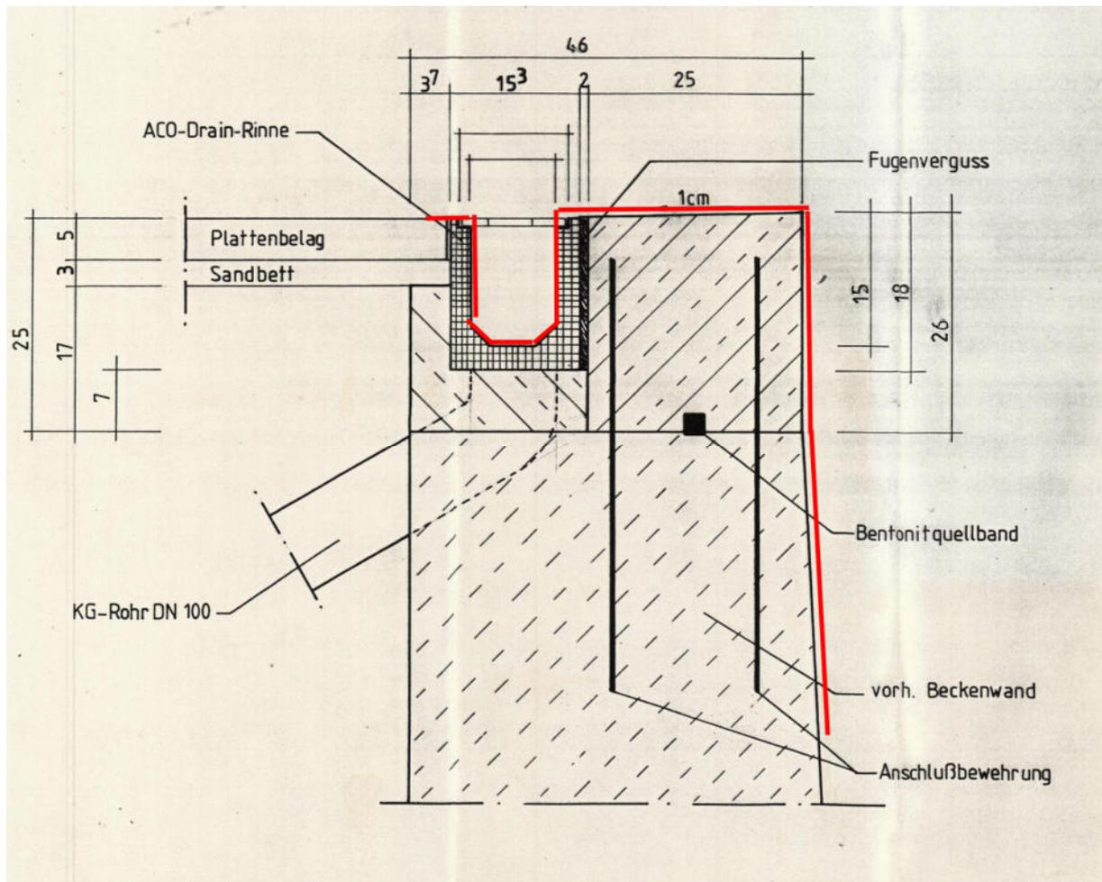
Die Badeplatte wird aufgrund der Veränderungen der Nutzungsbereiche ebenfalls Pflaster-technisch erneuert. Die vorhandenen Waschbetonplatten im Sandbett werden demontiert und durch neues Pflaster ersetzt. Ebenfalls wird die Badeplatte um den Teil des Kinderbeckens sowie um den Teil der Breitwasserrutsche für den ordnungsgemäßen Beckenumgang erweitert.
