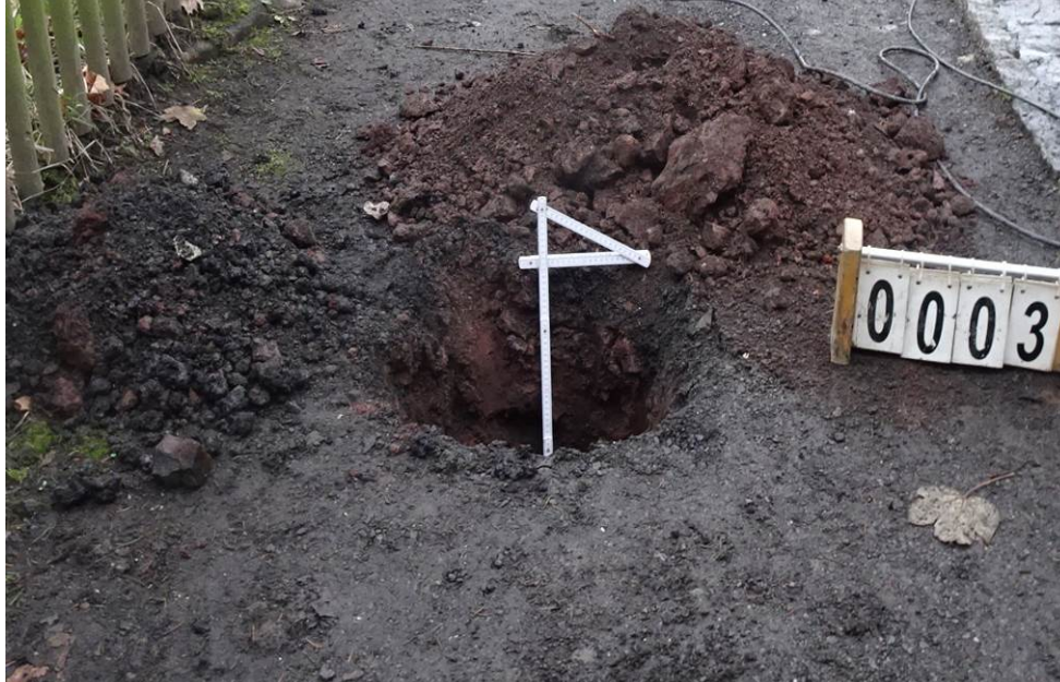
Bild 9: Entnahmestelle 3, Schurf S 3 Friedhofstraße zwischen Schlossplatz und Cainsdorfer Straße Station km 0+305, 6,7 m v. re. FBR, links Material der einzelnen Schichten ausgebaut
