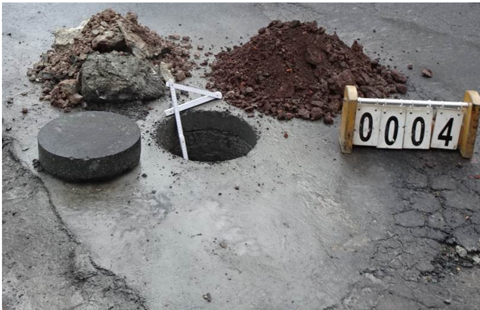
Bild 12: Entnahmestelle 4, Bohrkern BK 4, Schurf S 4 Friedhofstraße zwischen Schlossplatz und Cainsdorfer Straße Station km 0+308, 4,6 m v. re. FBR, links Material der einzelnen Schichten ausgebaut
