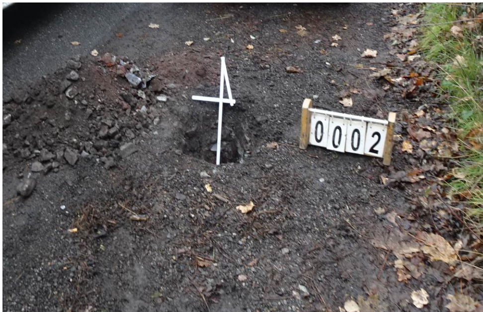
Bild 6: Entnahmestelle 2, Schurf S 2 Friedhofstraße zwischen Schlossplatz und Cainsdorfer Straße Station km 0+246, -1,1 m v. re. FBR, rechts Material der einzelnen Schichten ausgebaut
