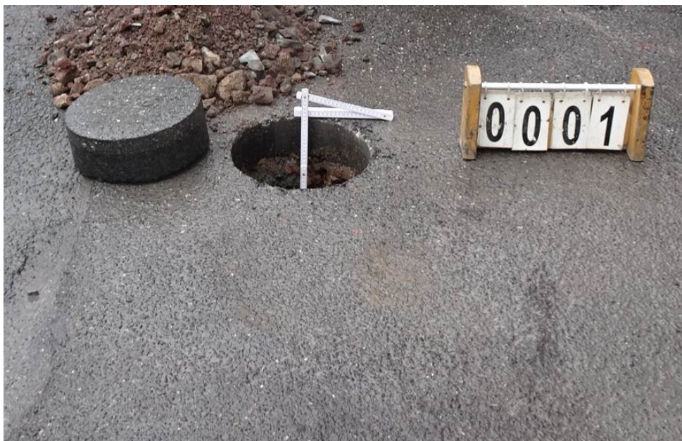
Bild 2: Entnahmestelle 1, Bohrkern BK 1, Schurf S 1 Friedhofstraße zwischen Schlossplatz und Cainsdorfer Straße Station km 0+151, 1,3 m v. re. FBR, rechts Material der einzelnen Schichten ausgebaut
