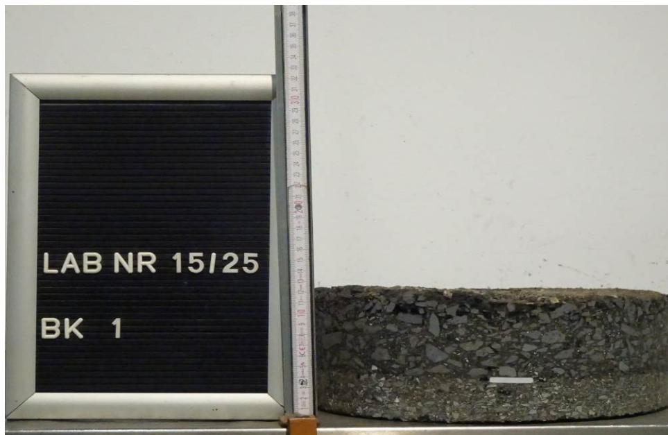
Bild 4: Entnahmestelle 1 Friedhofstraße zwischen Schlossplatz und Cainsdorfer Straße Station km 0+151, 1,3 m v. re. FBR, rechts Detail Bohrkern BK 1, Ø 300 mm
