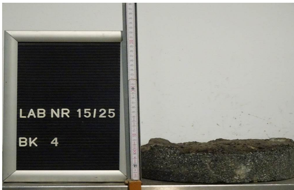
Bild 14: Entnahmestelle 4 Friedhofstraße zwischen Schlossplatz und Cainsdorfer Straße Station km 0+308, 4,6 m v. re. FBR, links Detail Bohrkern BK 4, Ø 300 mm
