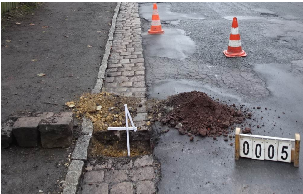
Bild 16: Entnahmestelle 5, Schurf S 5 Friedhofstraße zwischen Schlossplatz und Cainsdorfer Straße Station km 0+310, 5,5 m v. re. FBR, links Material der einzelnen Schichten ausgebaut
