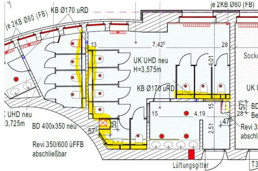
Hinweis: durch Rundung des Baukörpers in einigen Räumen keine rechtwinkligen Raumecken!
