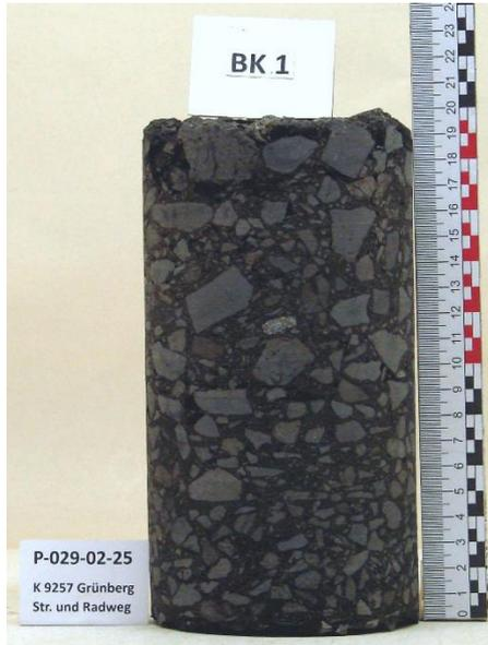
Fahrbahnoberkante im Foto an der Unterseite des Bohrkerns (Bohrkern steht auf dem Kopf!)
