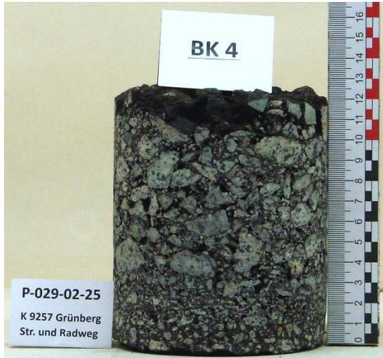
Fahrbahnoberkante im Foto an der Unterseite des Bohrkerns (Bohrkern steht auf dem Kopf!)
