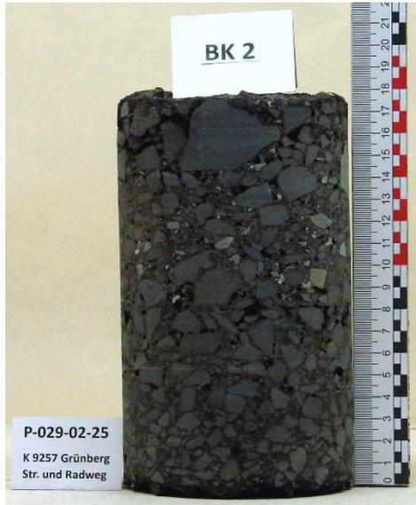
Fahrbahnoberkante im Foto an der Unterseite des Bohrkerns (Bohrkern steht auf dem Kopf!)
