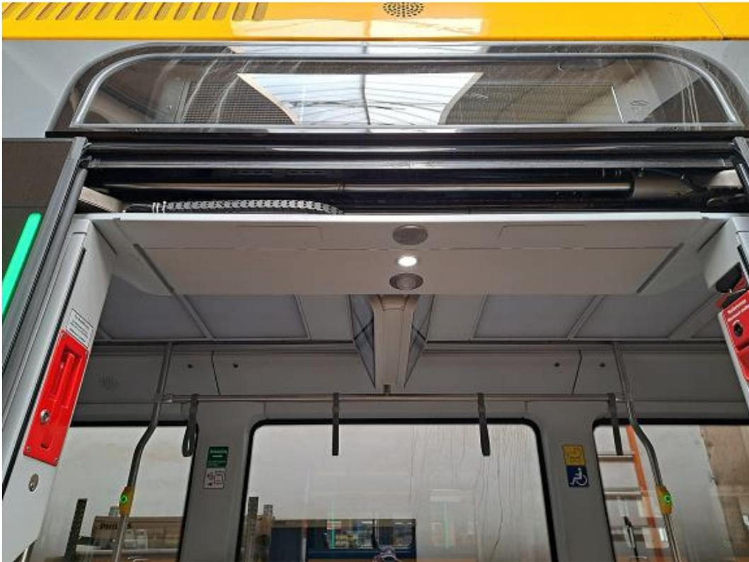
Montagevorbereitung an einer Doppeltür – mit Abdeckungen verschlossen
