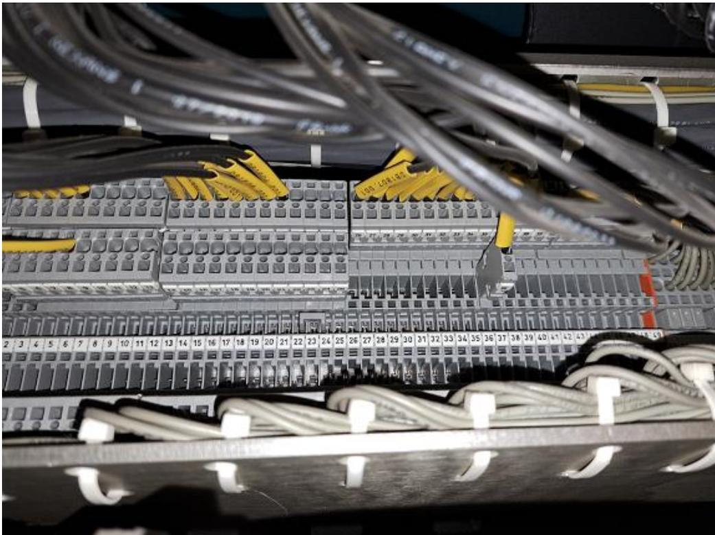
Klemmblock bei einem bereits ausgerüsteten Zählfahrzeug mit verwendeten Türkontakt an Klemme 36
