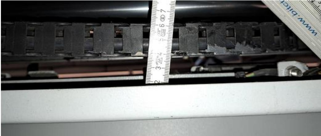
Es kann von einem verfügbaren Freiraum (nach oben) innerhalb der Türvouten von 30 mm ausgegangen werden.
