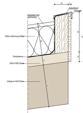
Detail Dachaufbauten M 1:10
