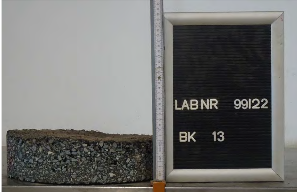
Bild 51: Entnahmestelle 13 Ausbau der Mottelerstraße in Zwickau Station km 0+318, 5,8 m v. re. FBR, links Detail Bohrkern BK 13, Ø 300 mm
