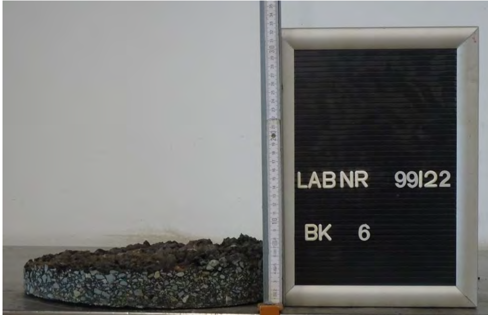
Bild 23: Entnahmestelle 6 Ausbau der Mottelerstraße in Zwickau Station km 0+131, 1,4 m v. re. FBR, rechts Detail Bohrkern BK 6, Ø 300 mm
