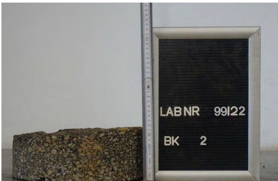
Bild 8: Entnahmestelle 2 Ausbau der Mottelerstraße in Zwickau Station km 0+038, -0,8 m v. re. FBR, rechts Detail Bohrkern BK 2, Ø 300 mm
