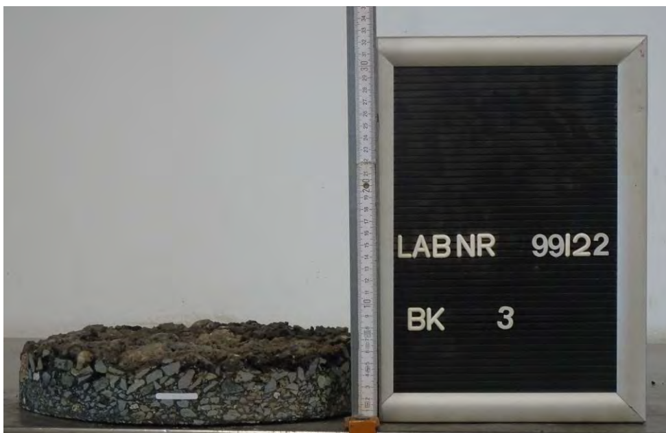
Bild 12: Entnahmestelle 3 Ausbau der Mottelerstraße in Zwickau Station km 0+038, 2,0 m v. re. FBR, rechts Detail Bohrkern BK 3, Ø 300 mm
