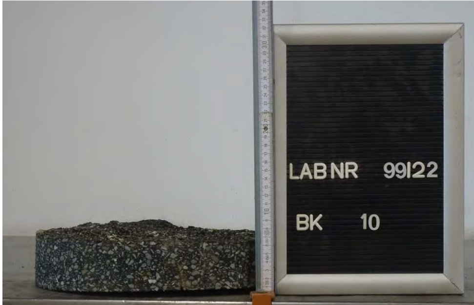
Bild 39: Entnahmestelle 10 Ausbau der Mottelerstraße in Zwickau Station km 0+222, 5,4 m v. re. FBR, links Detail Bohrkern BK 10, Ø 300 mm
