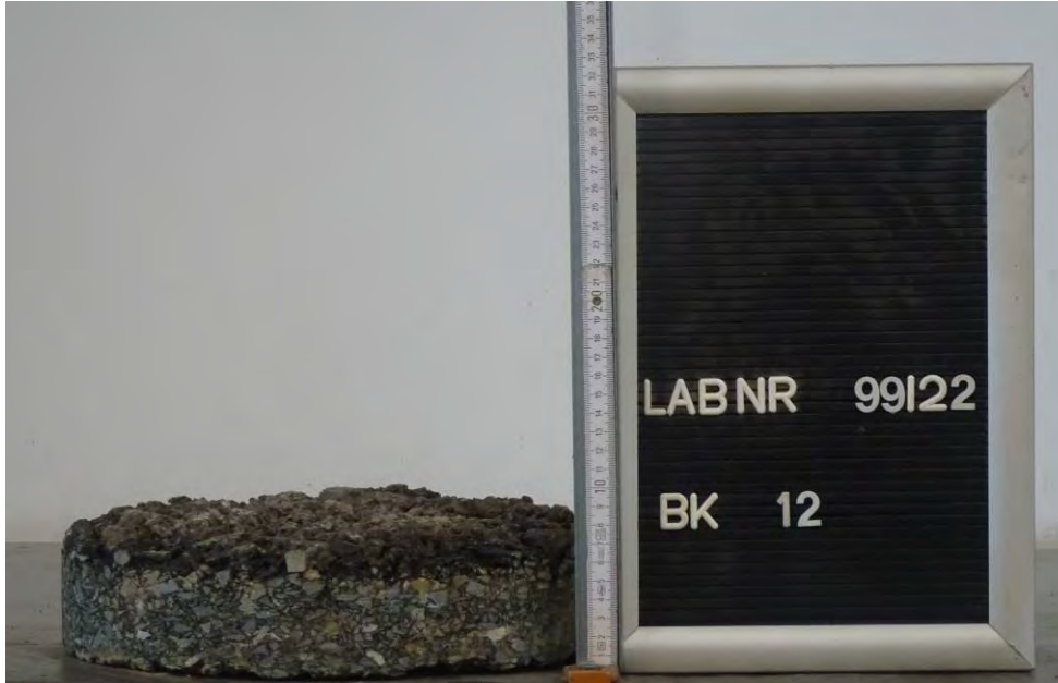
Bild 47: Entnahmestelle 12 Ausbau der Mottelerstraße in Zwickau Station km 0+332, 3,5 m v. re. FBR, links Detail Bohrkern BK 12, Ø 300 mm
