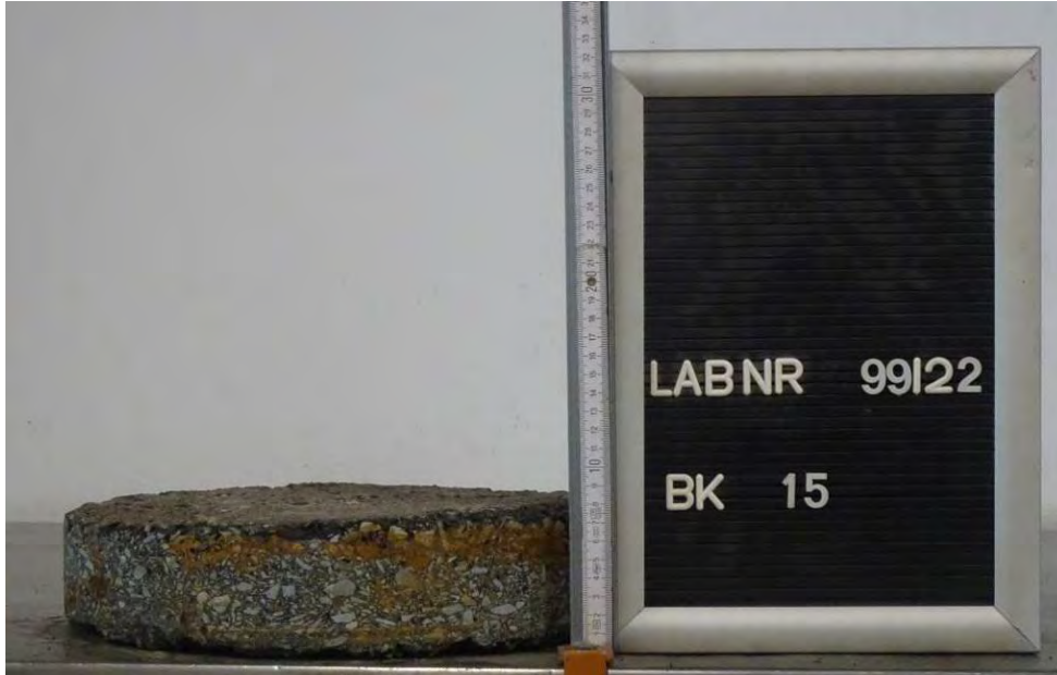
Bild 59: Entnahmestelle 15 Ausbau der Mottelerstraße in Zwickau Station km 0+479, 3,6 m v. re. FBR, links Detail Bohrkern BK 15, Ø 300 mm
