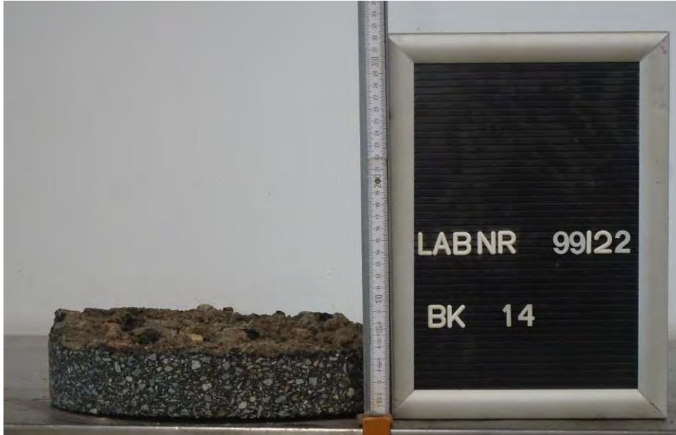
Bild 55: Entnahmestelle 14 Ausbau der Mottelerstraße in Zwickau Station km 0+487, -0,5 m v. re. FBR, rechts Detail Bohrkern BK 14, Ø 300 mm
