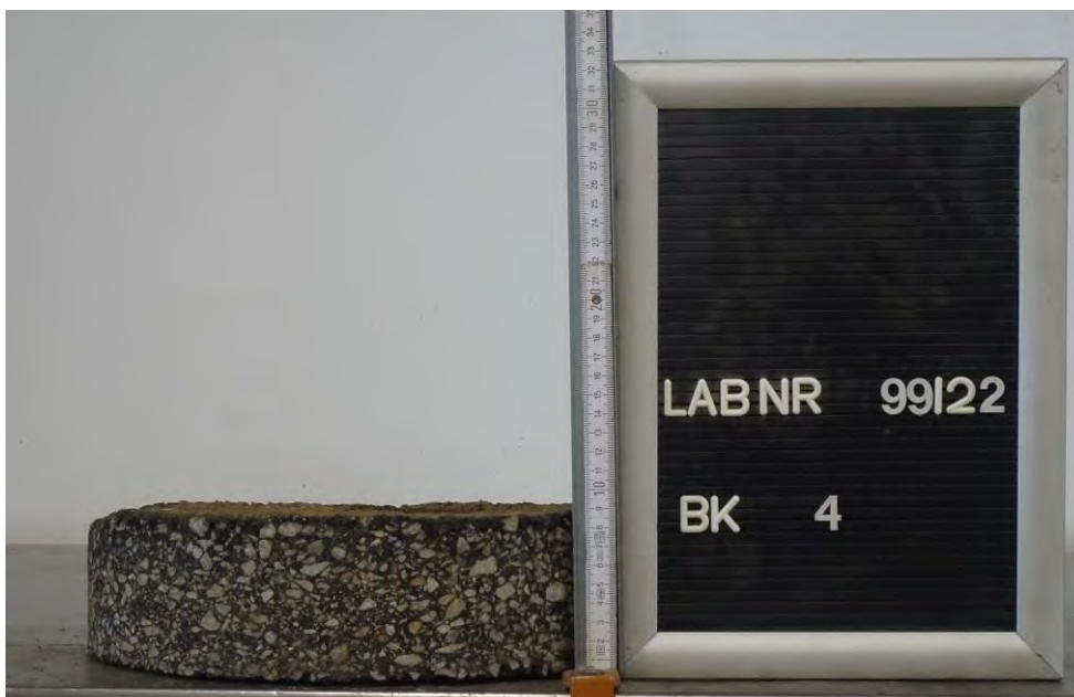
Bild 16: Entnahmestelle 4 Ausbau der Mottelerstraße in Zwickau Station km 0+087, 6,1 m v. re. FBR, links Detail Bohrkern BK 4, Ø 300 mm
