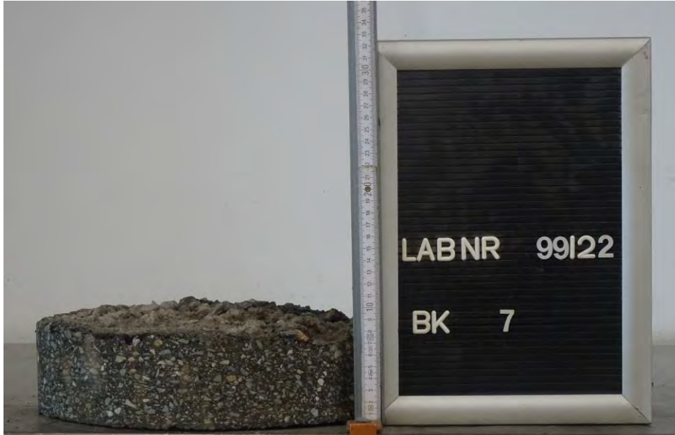
Bild 27: Entnahmestelle 7 Ausbau der Mottelerstraße in Zwickau Station km 0+200, -0,4 m v. re. FBR, rechts Detail Bohrkern BK 7, Ø 300 mm
