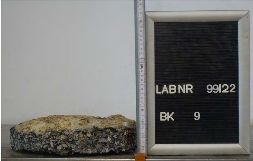
Bild 35: Entnahmestelle 9 Ausbau der Mottelerstraße in Zwickau Station km 0+269, 3,3 m v. re. FBR, links Detail Bohrkern BK 9, Ø 300 mm
