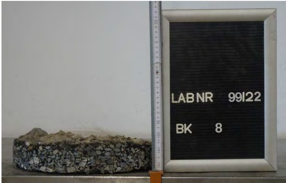
Bild 31: Entnahmestelle 8 Ausbau der Mottelerstraße in Zwickau Station km 0+188, 3,7 m v. re. FBR, links Detail Bohrkern BK 8, Ø 300 mm
