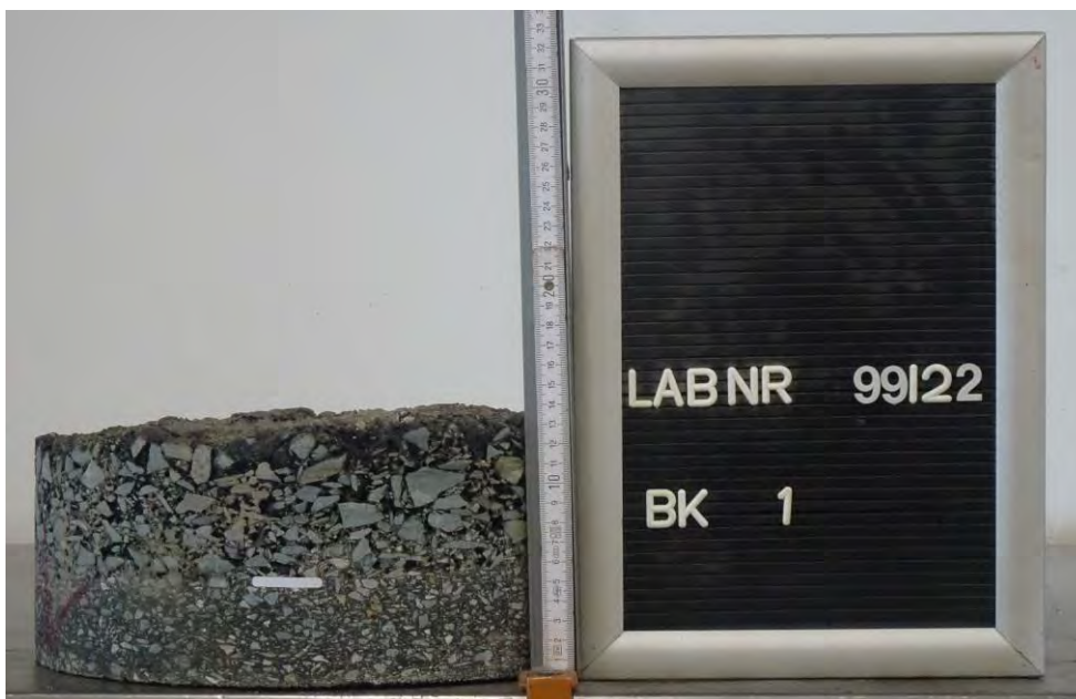
Bild 4: Entnahmestelle 1 Ausbau der Mottelerstraße in Zwickau Station km 0+003, 0,4 m v. re. FBR, rechts Detail Bohrkern BK 1, Ø 300 mm
