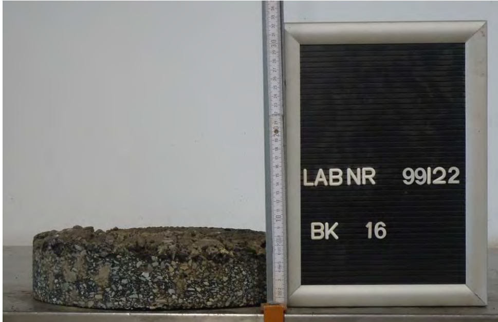
Bild 63: Entnahmestelle 16 Ausbau der Mottelerstraße in Zwickau Station km 0+493, 6,0 m v. re. FBR, links Detail Bohrkern BK 16, Ø 300 mm
