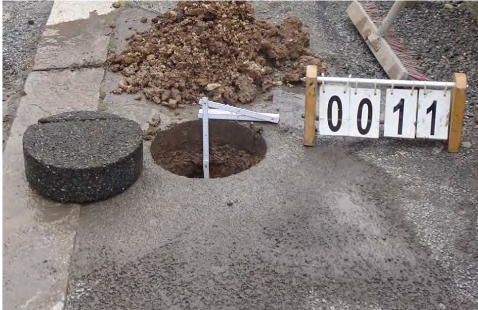
Bild 41: Entnahmestelle 11, Bohrkern BK 11, Schurf S 11 Ausbau der Mottelerstraße in Zwickau Station km 0+321, -0,6 m v. re. FBR, rechts Material der einzelnen Schichten ausgebaut
