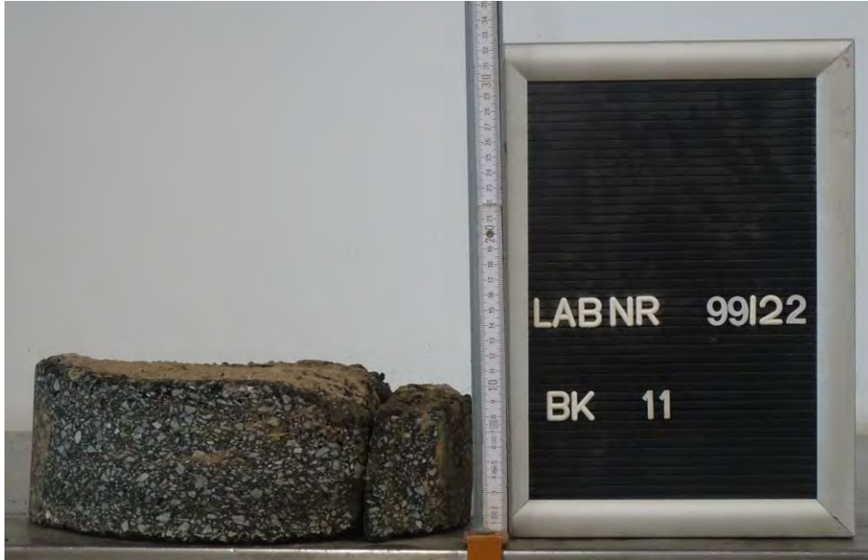
Bild 43: Entnahmestelle 11 Ausbau der Mottelerstraße in Zwickau Station km 0+321, -0,6 m v. re. FBR, rechts Detail Bohrkern BK 11, Ø 300 mm
