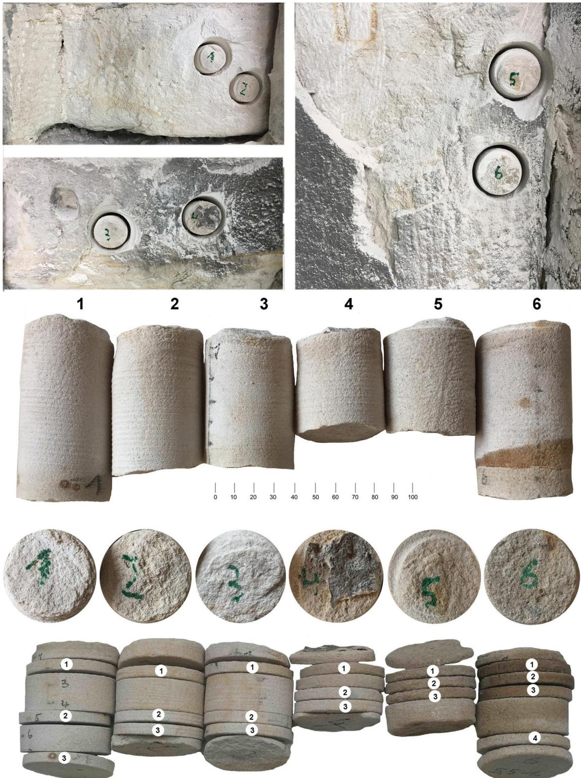
Abbildung 14. Bohrkerne 1, 3 und 6 für KSE-Festigungsverfahren (Kerne 2, 4 und 4 Referenzproben)
