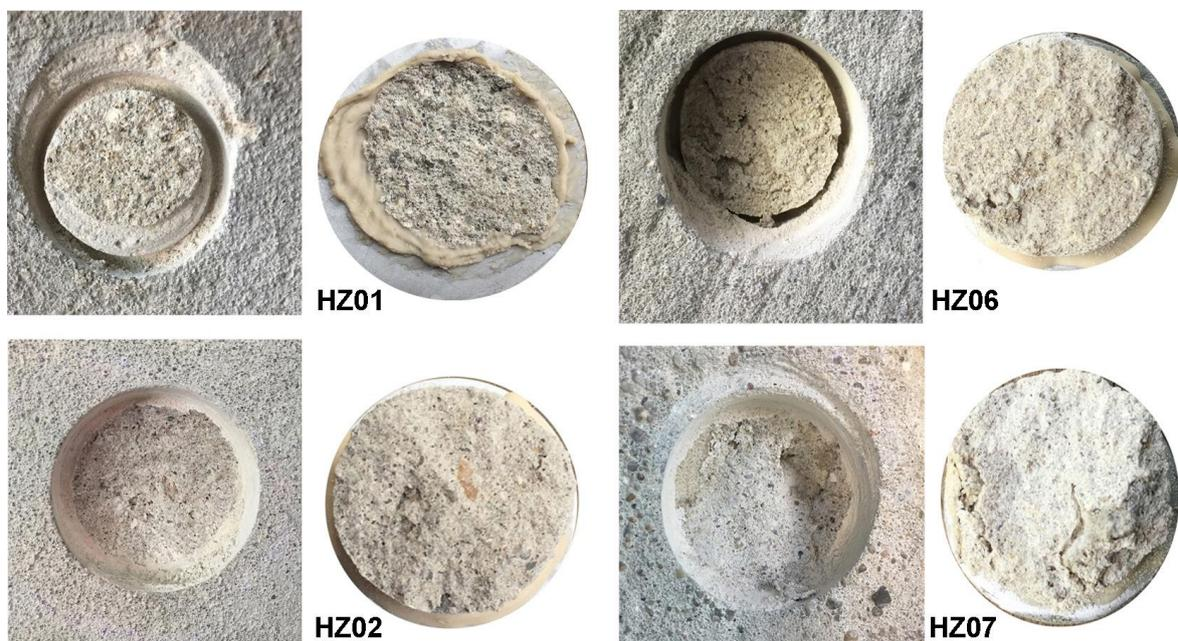
**Abbildung 6: Abrissflächen bei Haftzugfestigkeitsprüfung**
