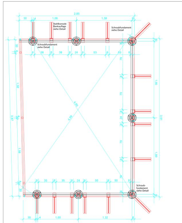
M 1:25 Beeteinfassung mit Unterkonstruktion aus feuerverzinkten Stahl und gehwegseitigen Geländer
