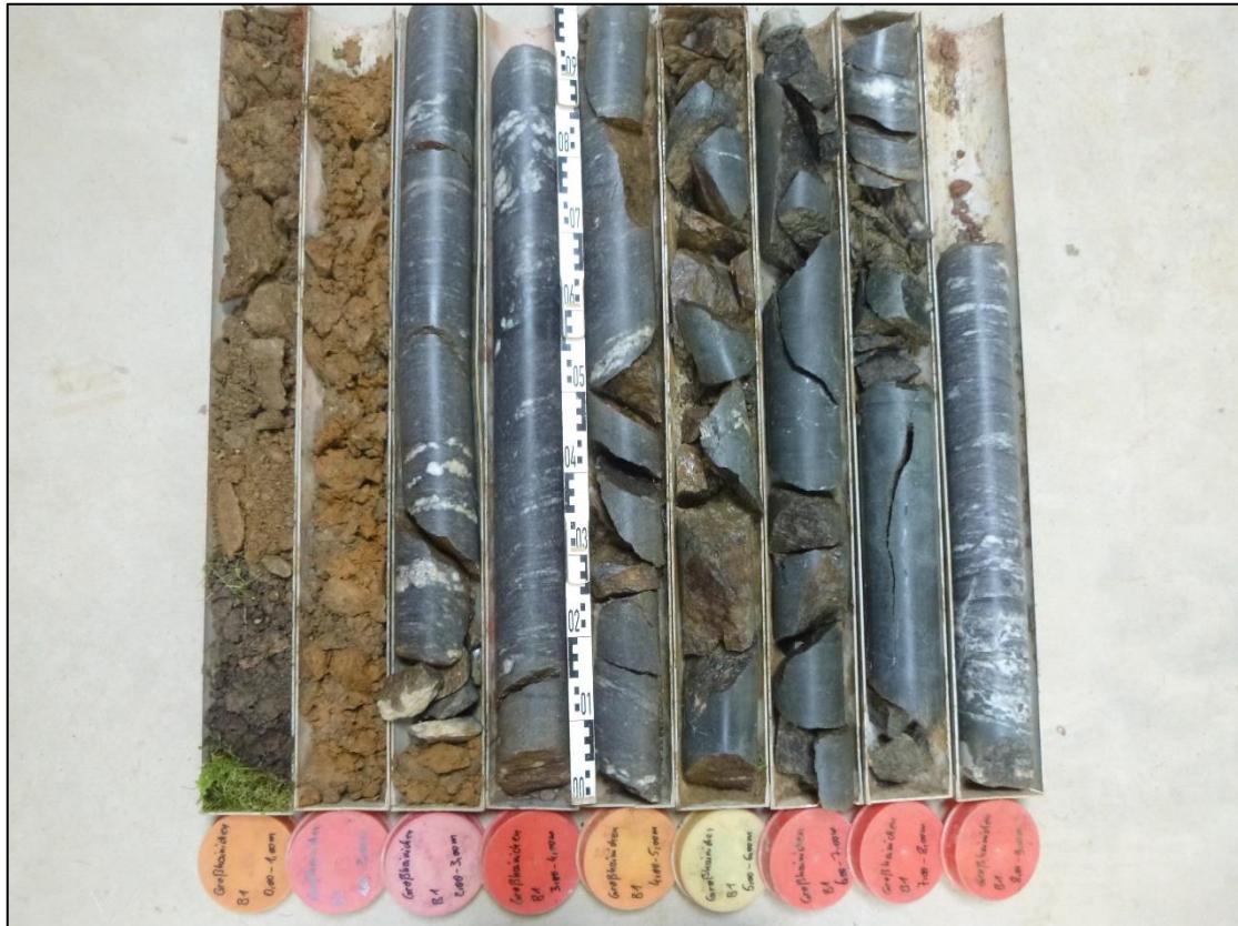
Bild 7: Rotationskernbohrung (B 1) – Detailansicht Bohrkern
