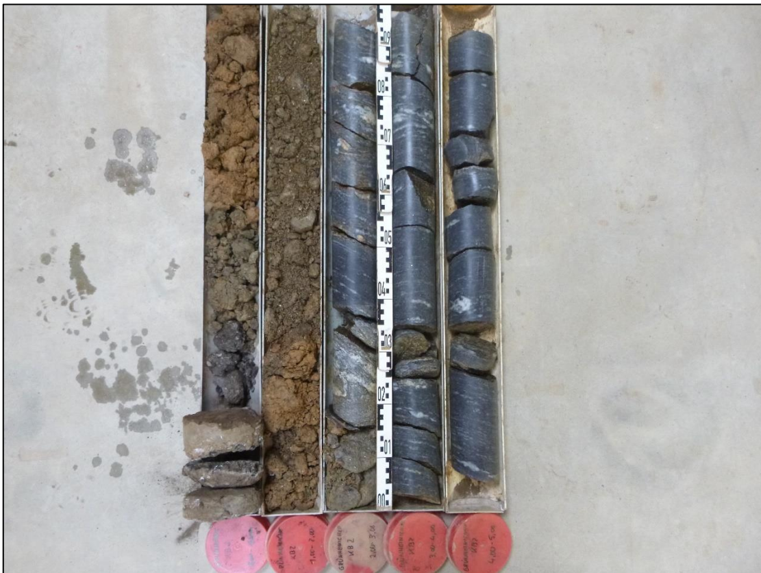
Bild 10: Rotationskernbohrung (B 2) – Detailansicht Bohrkern
