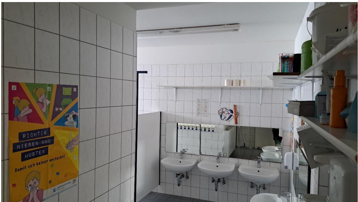
Abbildung 4.14 im Sanitärbereich sind Boden und Wände gefliest, Baugrundlage sind Gipswerkstoffplatten (LV-Pos. 2.5.3. bzw. 2.5.2.)
