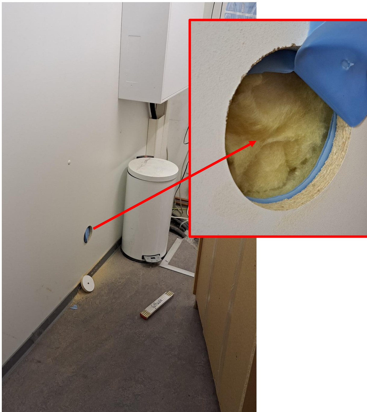
Abbildung 1: Wandöffnung Innenwand im HA-Raum R16 zur Entnahme der Probe
