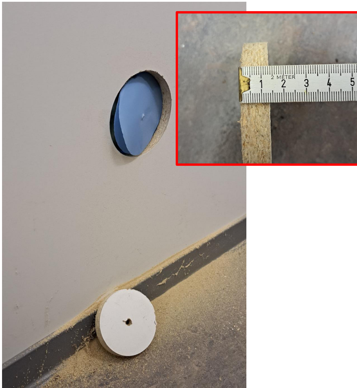
Abbildung 1: Wandöffnung im HA-Raum R16 zur Entnahme der Probe IW KMF ; hier sowie aus der Entnahmestelle von Probe AW KMF wurden die beiden Holzscheiben als Probe Holz entnommen
