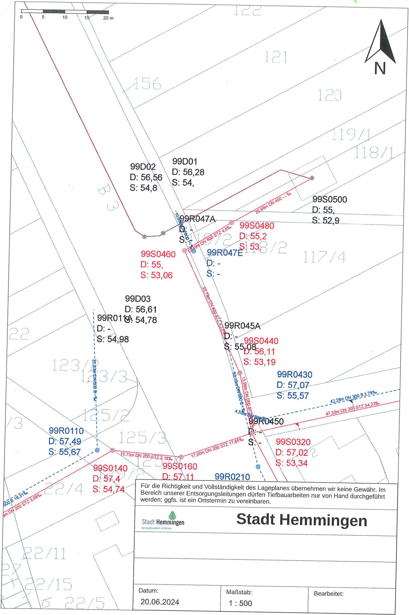
Für die Richtigkeit und Vollständigkeit des Lageplanes übernehmen wir keine Gewähr. Im Bereich unserer Entsorgungsleitungen dürfen Tiefbauarbeiten nur von Hand durchgeführt werden; ggfs. ist ein Ortstermin zu vereinbaren.
