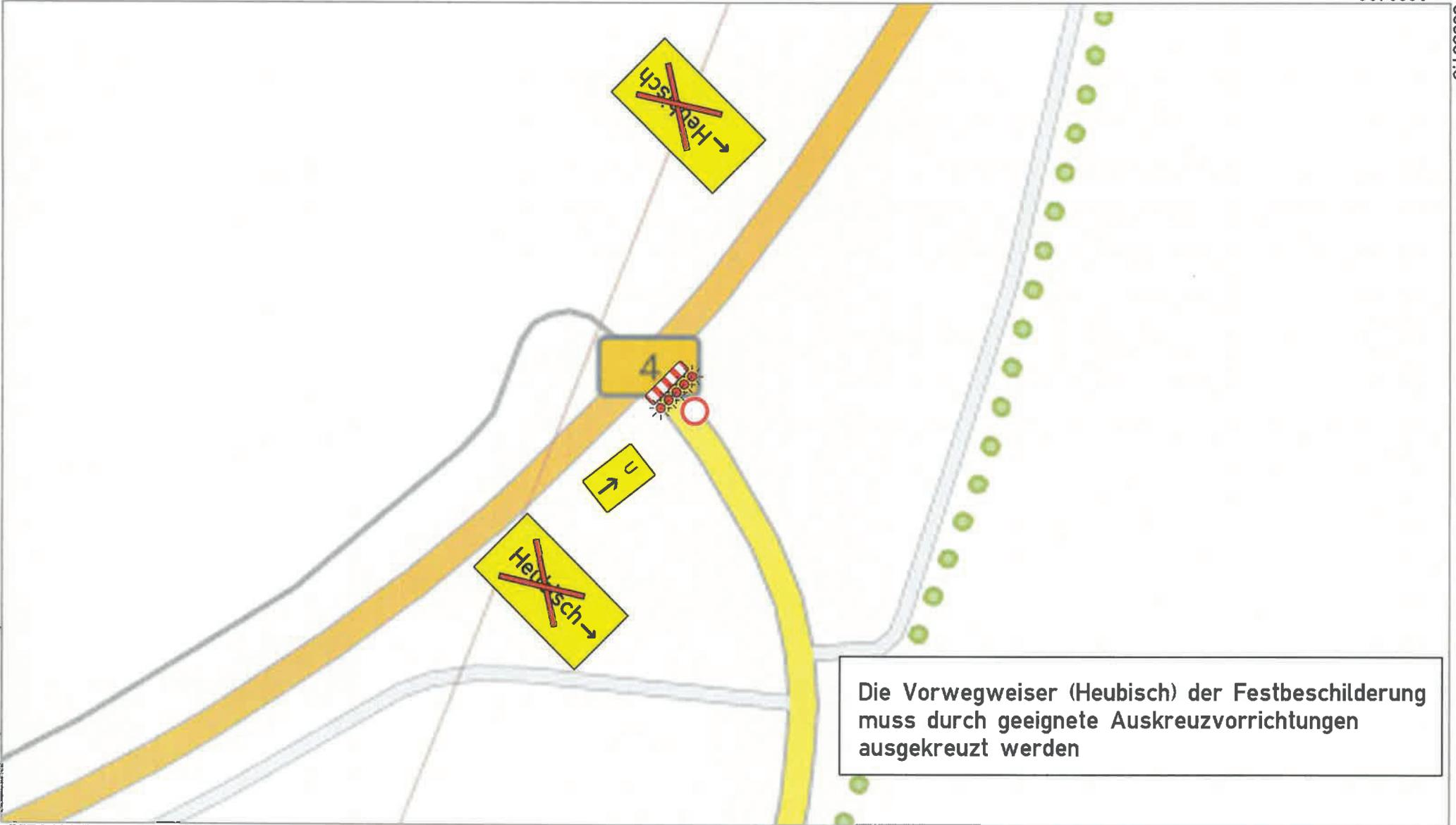
Die Vorwegweiser (Heubisch) der Festbeschilderung muss durch geeignete Auskreuzvorrichtungen ausgekreuzt werden
