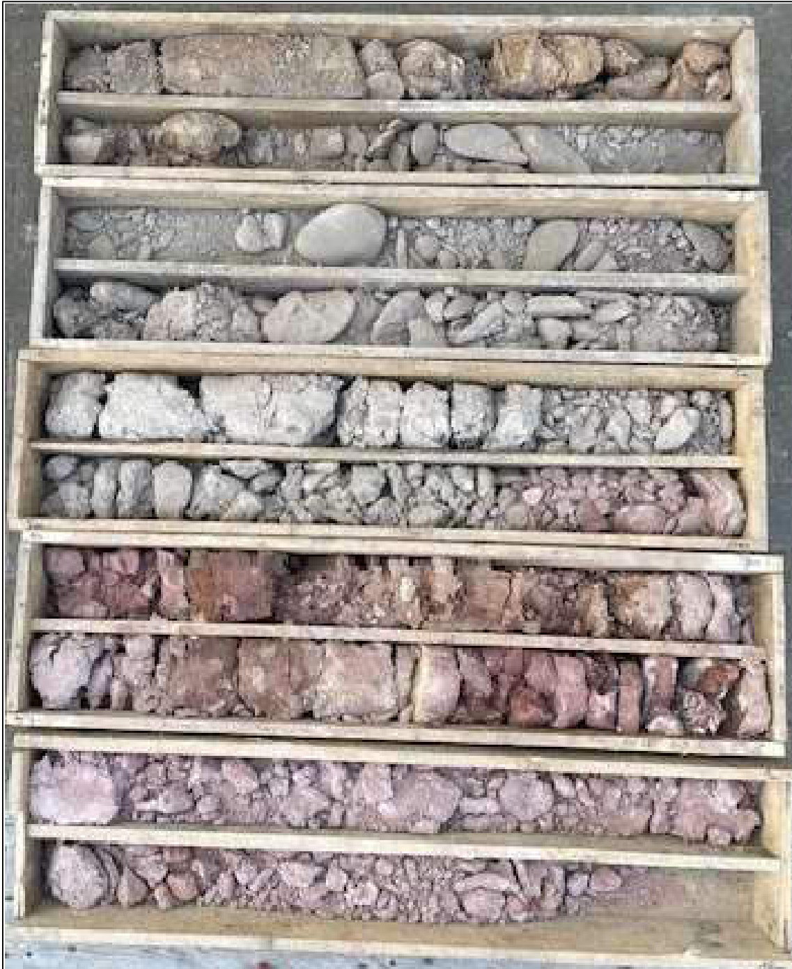
Bild 6: Kernkisten der Bohrung BK 006 (Bohrtiefe 0,0 m - 9,7 m)
