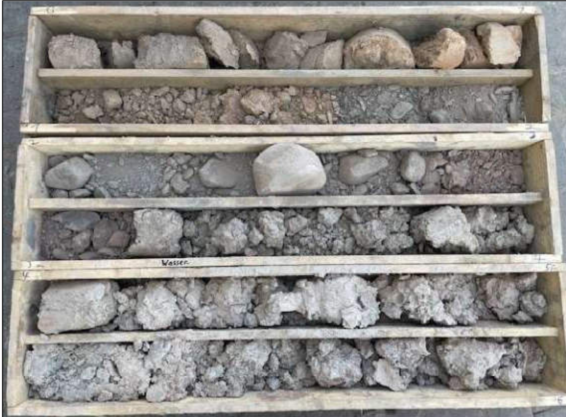
Bild 8: Kernkisten der Bohrung BK 008 (Bohrtiefe 0,0 m - 6,0 m)
