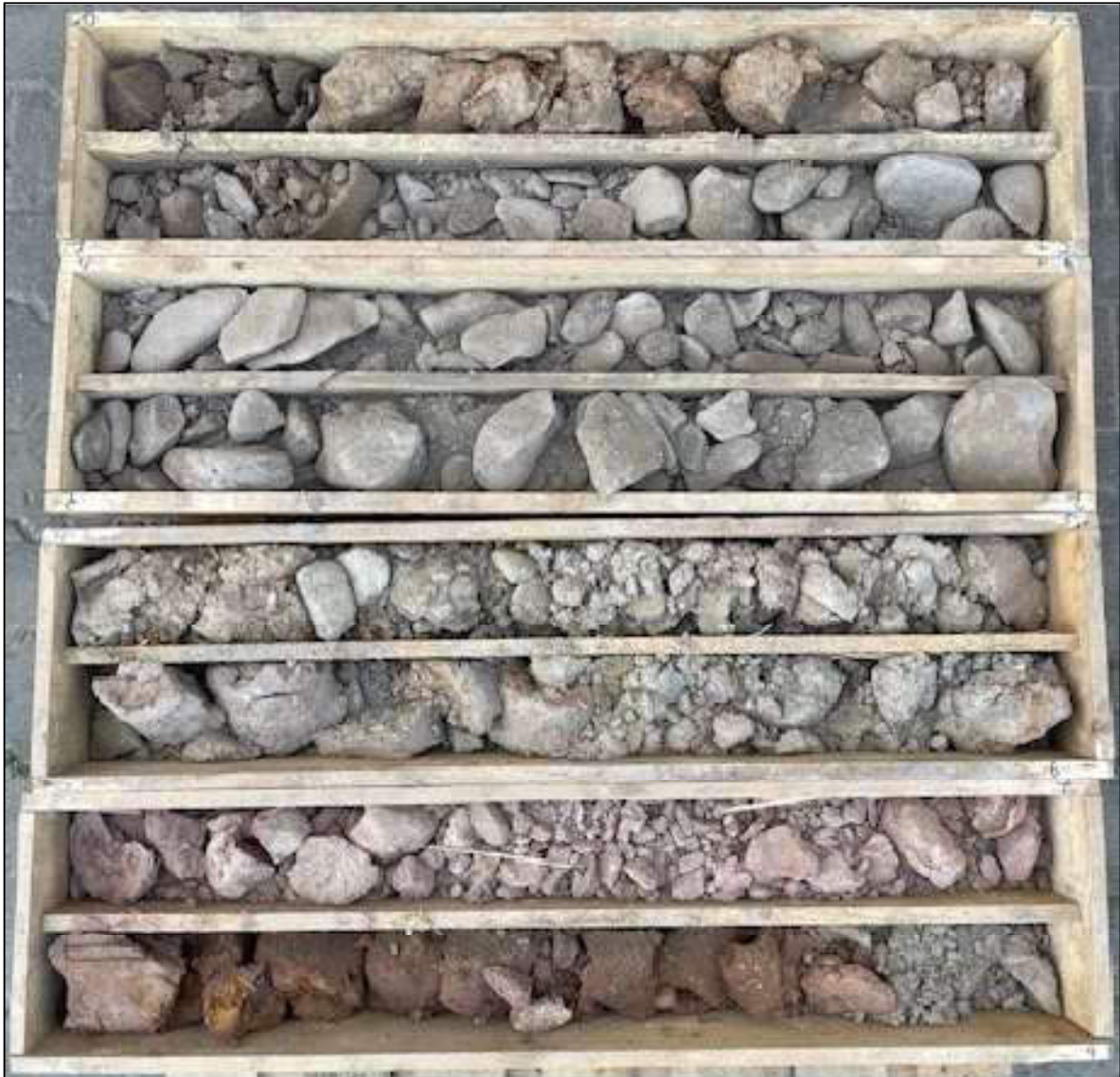
Bild 3: Kernkisten der Bohrung BK 003 (Bohrtiefe 0,0 m - 8,0 m)
