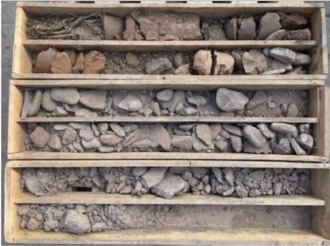
Bild 2: Kernkisten der Bohrung BK 002 (Bohrtiefe 0,0 m - 6,0 m)
