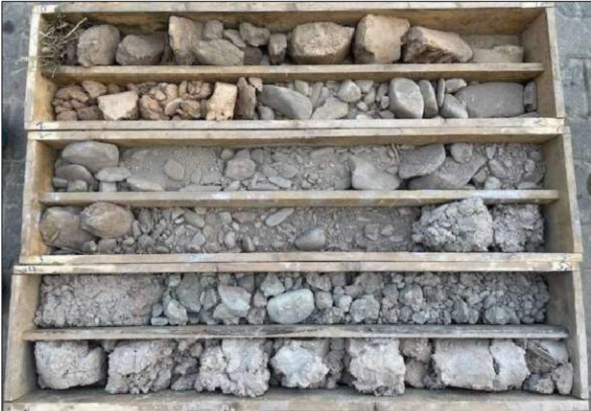
Bild 5: Kernkisten der Bohrung BK 005 (Bohrtiefe 0,0 m - 6,0 m)
