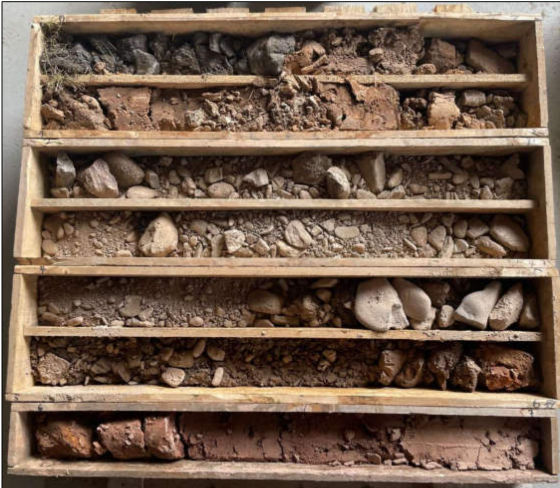
Bild 10: Kernkisten der Bohrung BK 010 (Bohrtiefe 0,0 m - 7,0 m)
