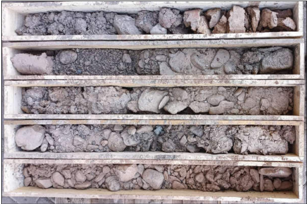
Bild 9: Kernkisten der Bohrung BK 009 (Bohrtiefe 0,0 m - 5,0 m)
