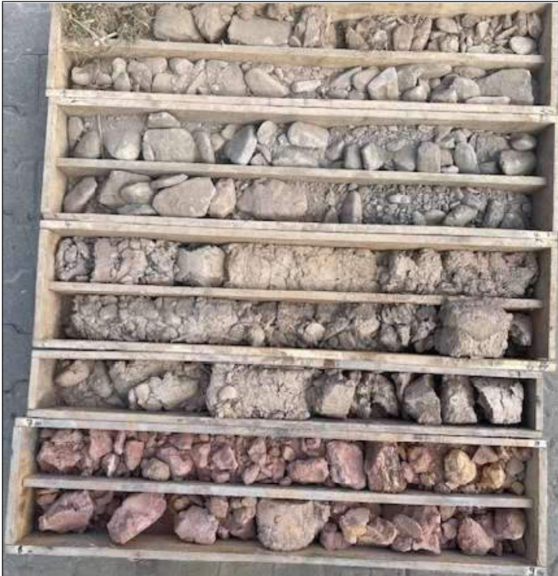
Bild 1: Kernkisten der Bohrung BK 001 (Bohrtiefe 0,0 m - 9,0 m)
