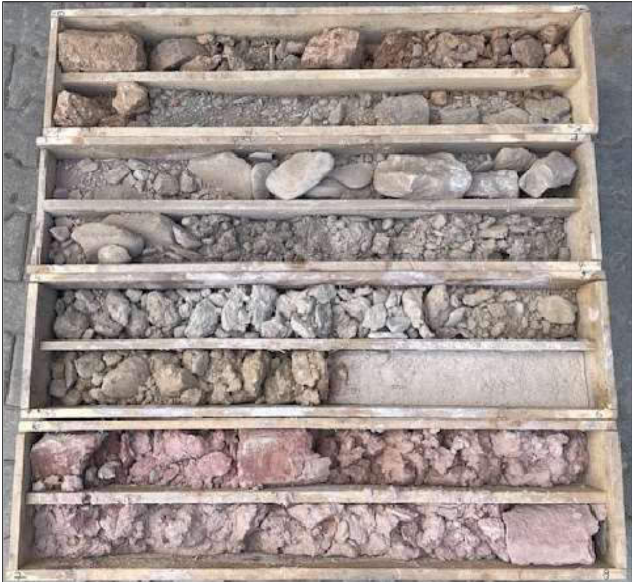
Bild 4: Kernkisten der Bohrung BK 004 (Bohrtiefe 0,0 m - 8,0 m)
