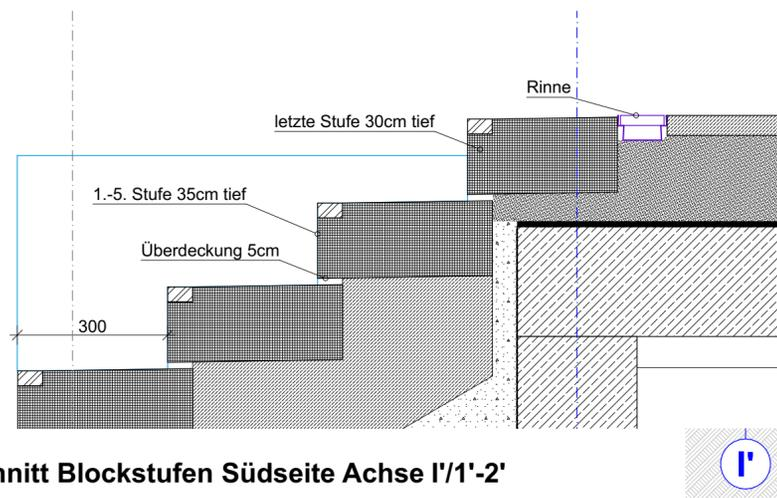
Detailschnitt Blockstufen Südseite Achse I'/1'-2'
