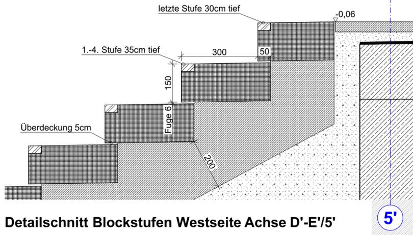
Detailschnitt Blockstufen Westseite Achse D'-E'/5'
