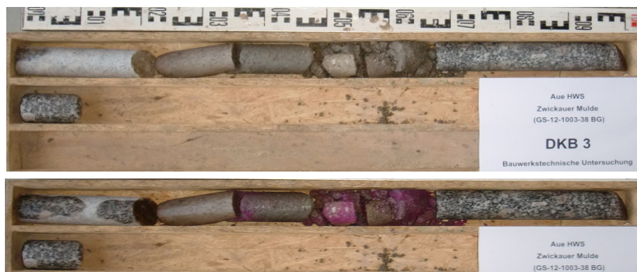
Abb. 9: DKB 3 – Bohrprofil, ohne und mit Phenolphthaleinlösung
