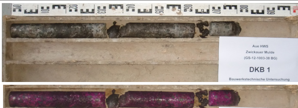
Abb. 3: DKB 1 – Bohrprofil, ohne und mit Phenolphthaleinlösung
