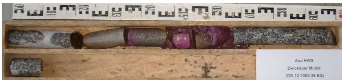
Testergebnis – Phenolphthaleinlösung (Karbonatisierung)
