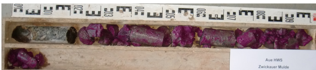
Testergebnis – Phenolphthaleinlösung (Karbonatisierung)
