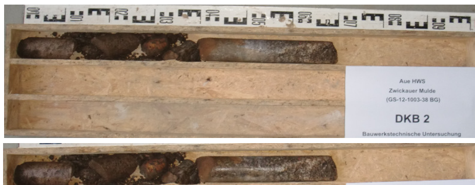
Abb. 6: DKB 2 – Bohrprofil, ohne und mit Phenolphthaleinlösung
