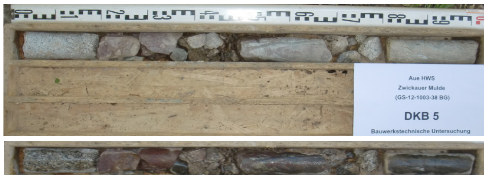
Abb. 15: DKB 5 – Bohrprofil, ohne und mit Phenolphthaleinlösung
