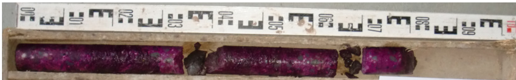
Testergebnis – Phenolphthaleinlösung (Karbonatisierung)
