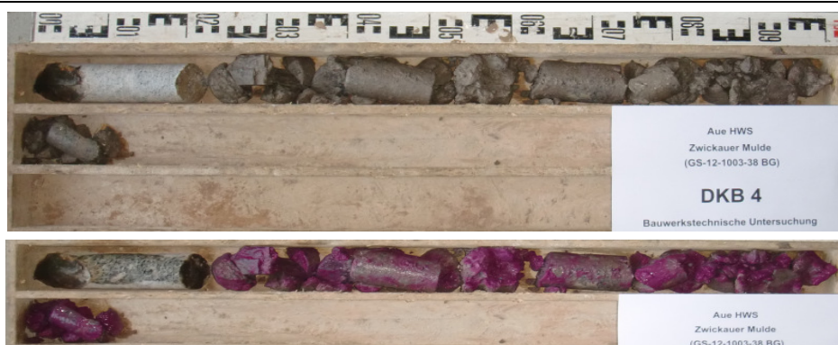
Abb. 12: DKB 4 – Bohrprofil, ohne und mit Phenolphthaleinlösung
