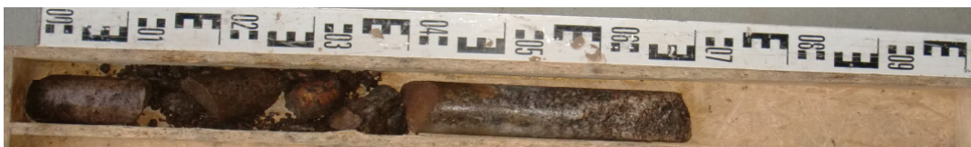
Testergebnis – Phenolphthaleinlösung (Karbonatisierung)
