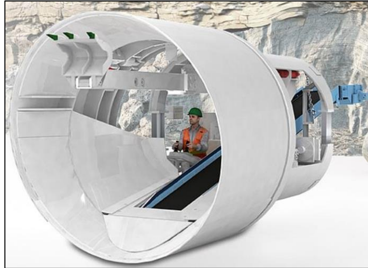
Abbildung 3: Teilschnittmaschine mit Exkavator [Herrenknecht]
