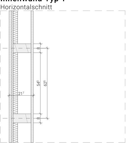
Ausführungshinweise Beplankung in Sanitärbereichen bei Typ 1b 2 Lagen Gipskartonbeplankung durch 2 imprägnierte GKBI-Platten ersetzen (6,5mm+12,5mm)bei Typ 3a Gipsfaserplatten reichen für Feuchträume aus
