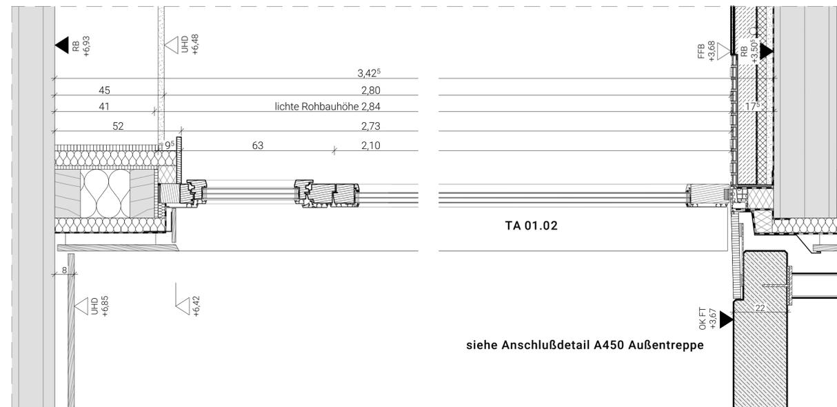
Vertikalschnitt Außentür TA 01.02 M 1:10
