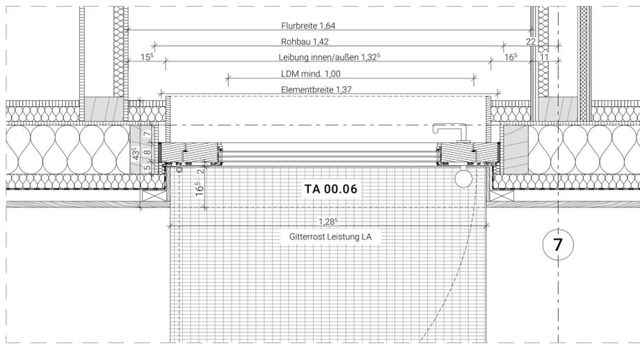
Horizontalschnitt Außentür TA 00.06 M 1:10
