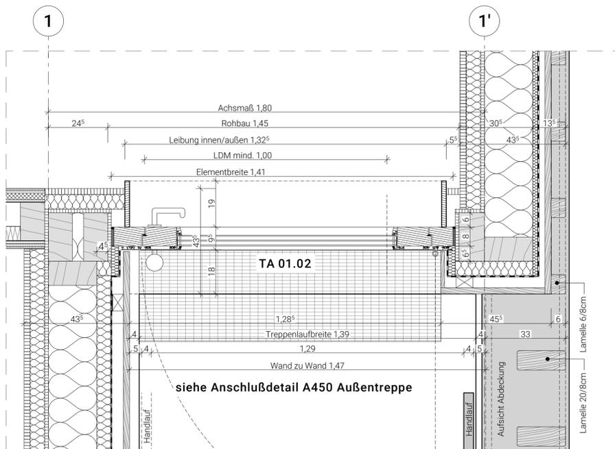
Horizontalschnitt Außentür TA 01.02 M 1:10
