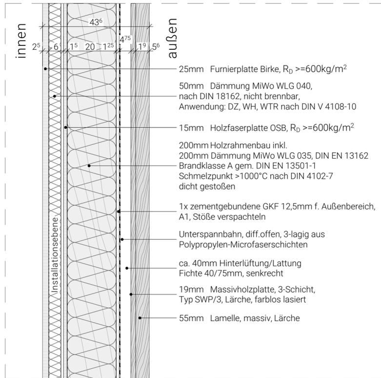
**Außenwand Typ 1 B (Lamelle) Vertikalschnitt**
