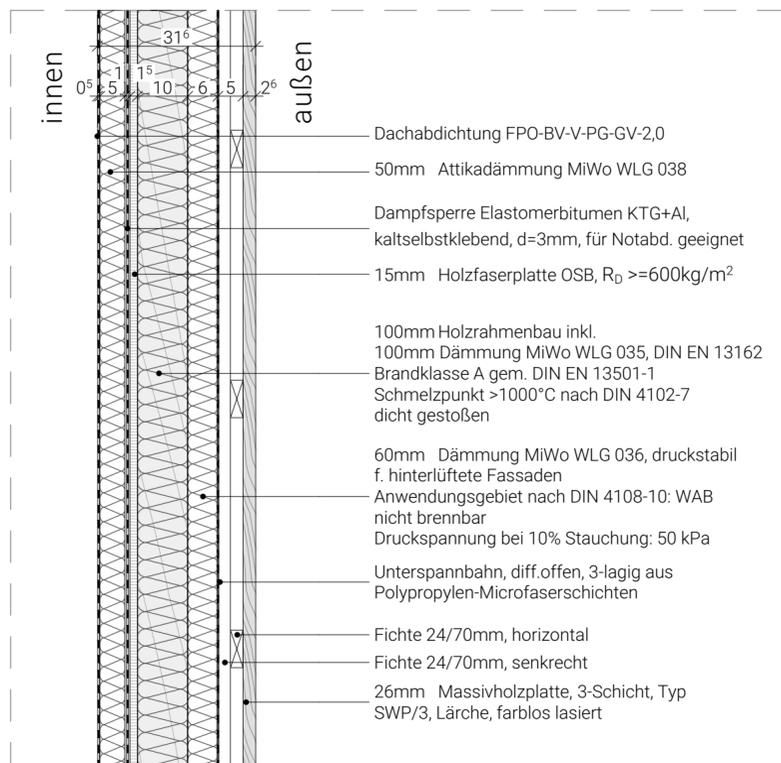
**Außenwand Typ 3, Attika (Vertikalschnitt)**
