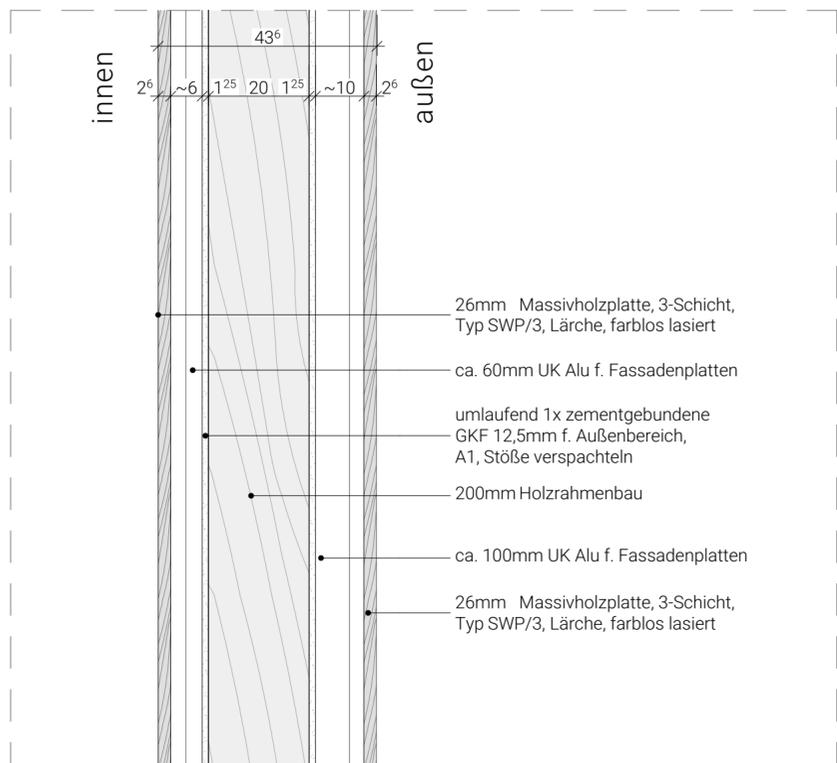
**Außenwand Typ 2, Laubengang (Vertikalschnitt)**
