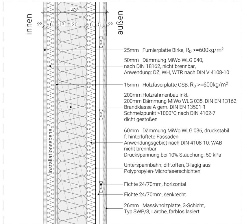
**Außenwand Typ 1 Vertikalschnitt**
