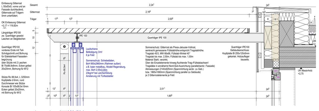
321-1.01: Querschnitt Pergola, Schiebläden, Gitterrost Sonnenschutz Südfassade
