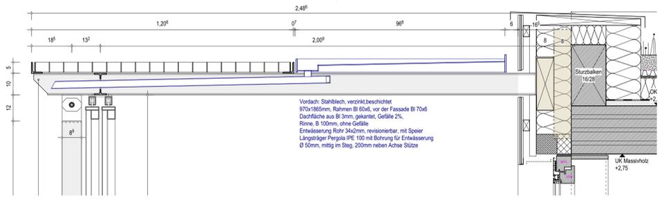
321-1.02: Querschnitt Pergola, Vordach, Gitterrost Sonnenschutz Westfassade
