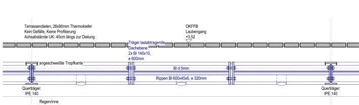
321-2.05: Längsschnitt Konstruktion Laufebene Laubengang
