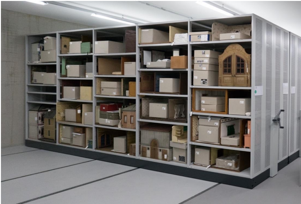
Fahrregal mit Fachboden, durchbrochene Front
