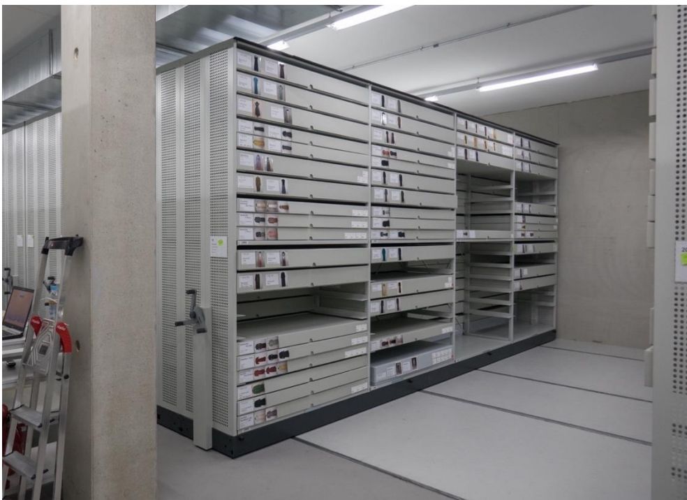
Fahrregal mit freitragenden Schachteln auf Winkelträgern, durchbrochene Front
