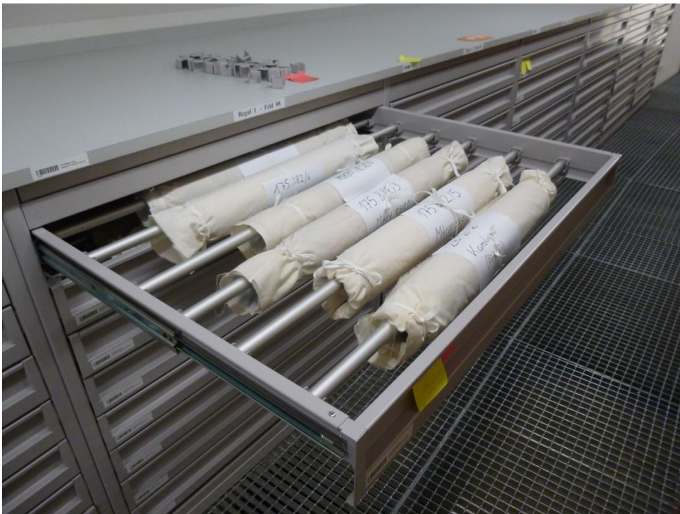
Rollenauszüge mit variabel einhängbaren Stangen
