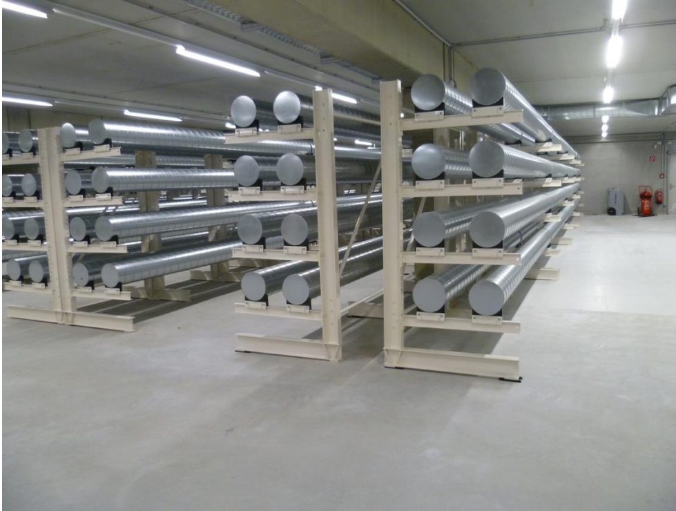
Kragarmregale für Tapisserien auf Wickelfalzrohren (leer)
