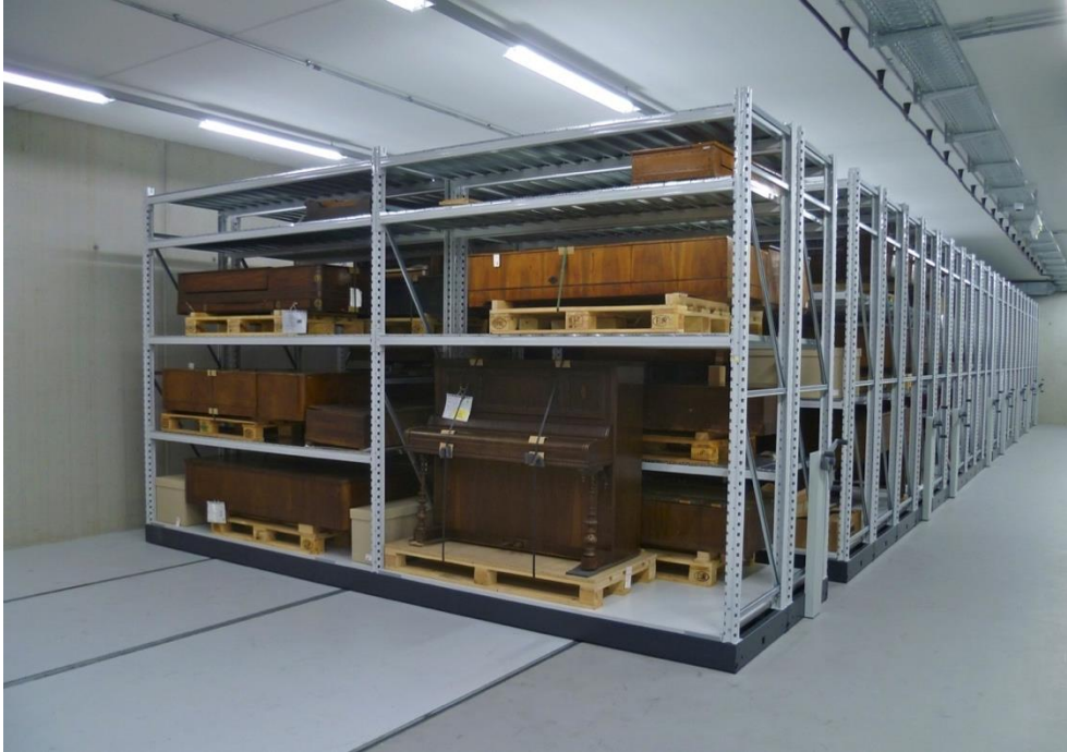
Fahrregal (Weitspannregal) mit Fachbodeneinlagen
