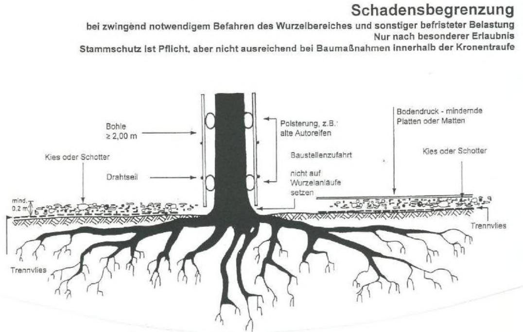
**Bild 4 Aufgrabungen im Wurzelbereich**
