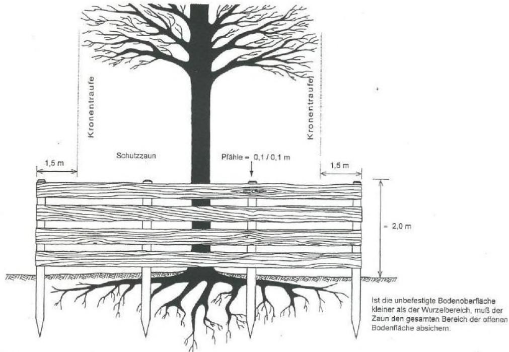
**Bild 2 Wurzeltellerschutz und Stammschutz**
