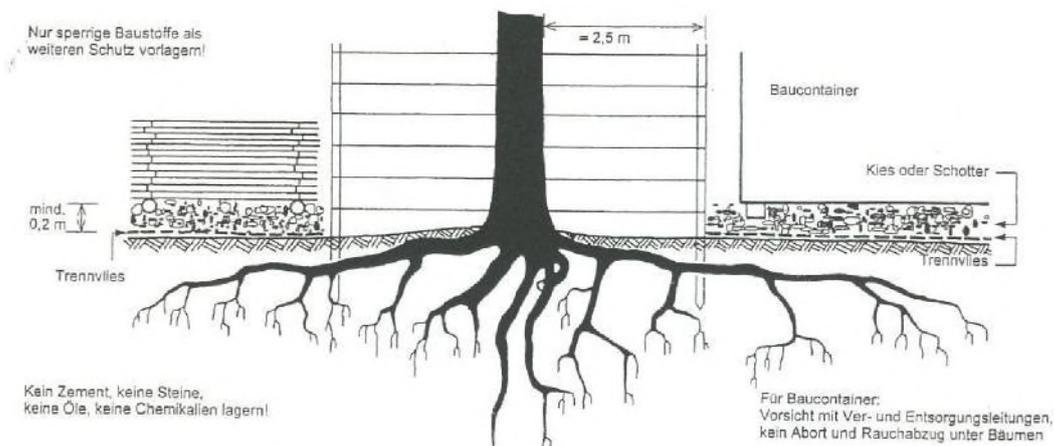
**Bild 3 Wurzeltellerschutz und Stammschutz mit Schutzmanschetten**
