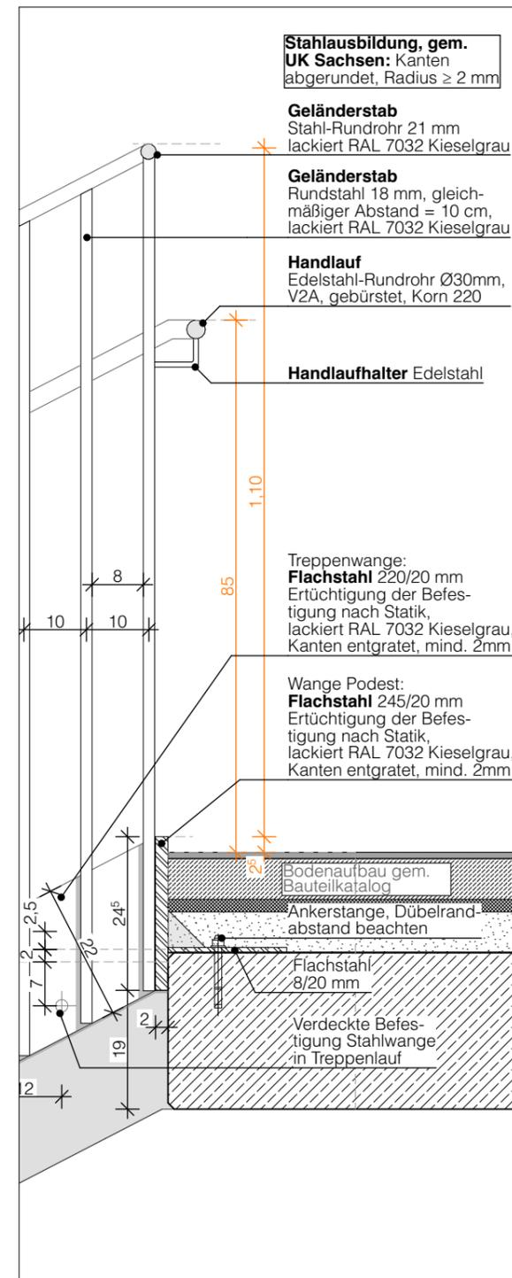
Querschnitt Treppenlauf 3 an PR-Fassade Anschluss Umwehrg und Handlauf, M 1:10
