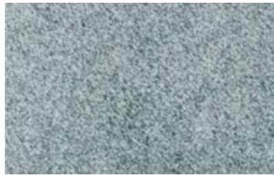
Abbildung: Vorbereitungsgrad Sa 2½
