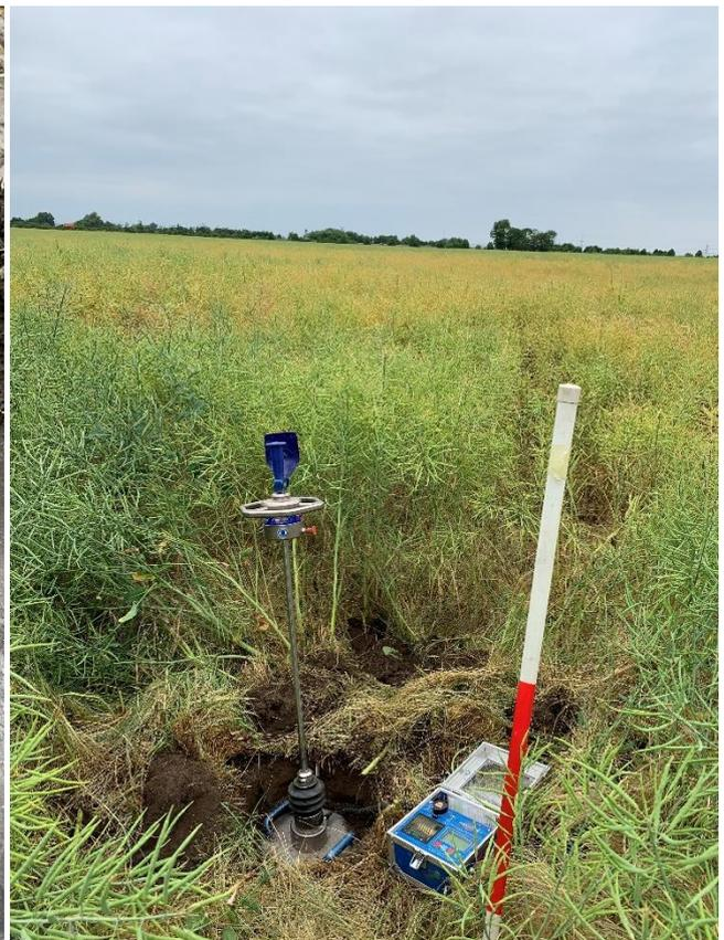
Abb. 3: Durchführung dynamischer Plattendruckversuch
