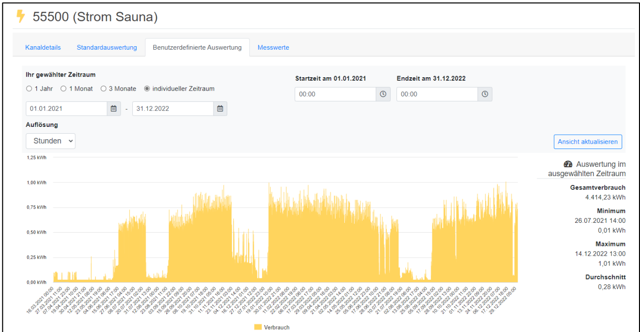
Abbildung 28 – stündlicher Stromverbrauch Sauna Stadtbad Plauen – Zeitraum 01/2021 –12/2022; Datenquelle: Stadt Plauen – INM - Monitoring, Screenshot Datenauswertung Software
