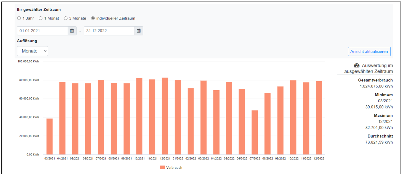
Abbildung 16 – monatliche Wärmelieferung BHKW Stadtbad Plauen – Zeitraum 03/2021 –12/2022; Datenquelle: Stadt Plauen – INM - Monitoring, Screenshot Datenauswertung Software
