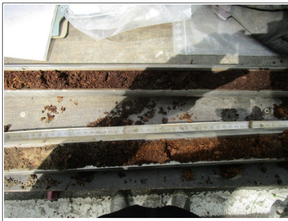
Abbildung 43: Radweg Sand oberhalb des Torfes
