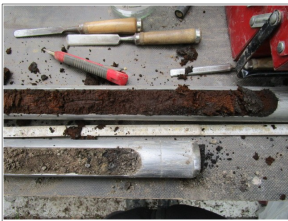
Abbildung 48: Fahrbahn rechts Unterhalb der Auffüllung Torfschicht
