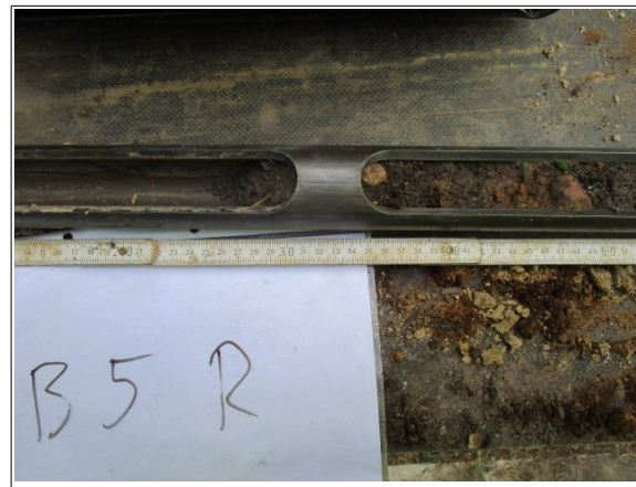
Abbildung 22: Bankett rechts Humose Deckschicht
