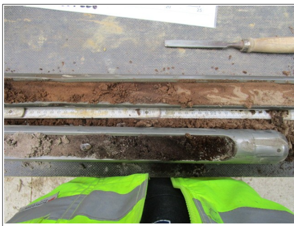
Abbildung 13: Fahrbahn links Auffüllungsboden bis in 1m Tiefe
