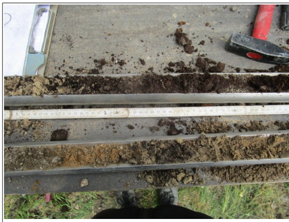
Abbildung 55: Radweg Auffüllungsboden bis 1,2m Tiefe
