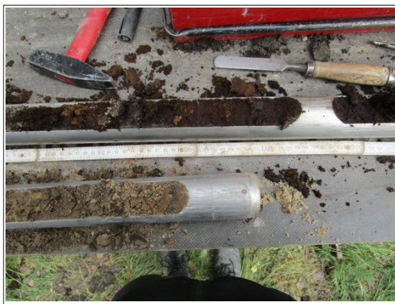
Abbildung 56: Radweg Unterhalb der Auffüllung Torf
