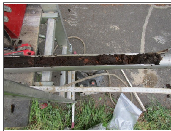
Abbildung 42: Radweg Unterhalb des Sandes Torfschicht
