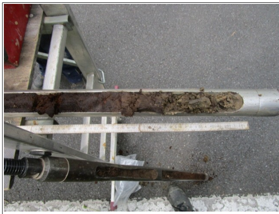
Abbildung 45: Radweg Erster Fund von Sand unterhalb des Torfes
