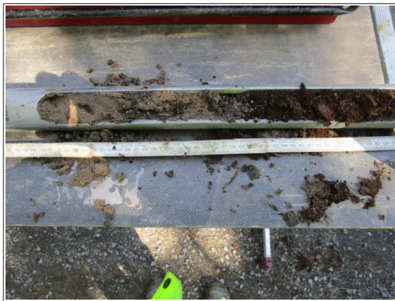
Abbildung 33: Fahrbahn links Erster Fund von Torf unter der Fahrbahn in 1,3m Tiefe
