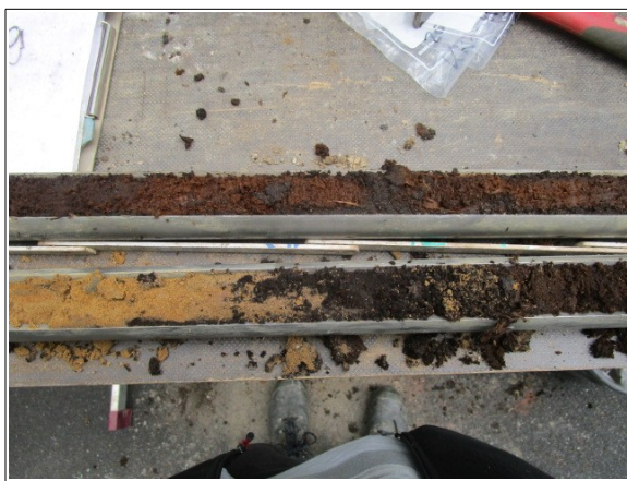
Abbildung 51: Radweg Sandschicht oberhalb des Torfes
