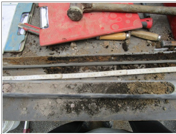
Abbildung 61: Fahrbahn links Auffüllungsboden bis 1,5m Tiefe
