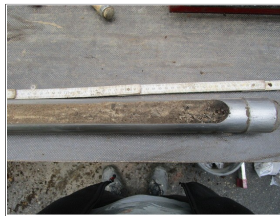
Abbildung 53: Bankett rechts Kein Torf unterhalb der Auffüllung
