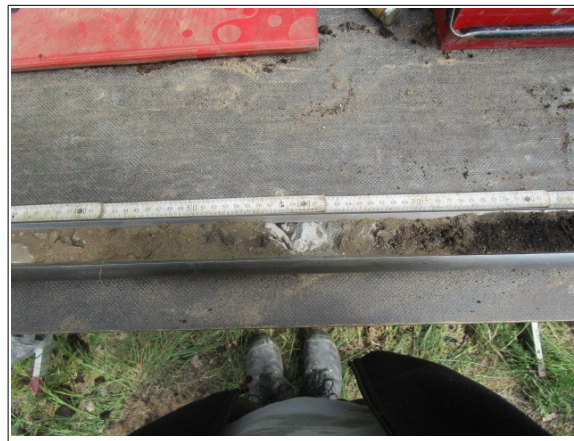
Abbildung 58: Bankett rechts Auffüllungsboden mit Betonbruchstücken
