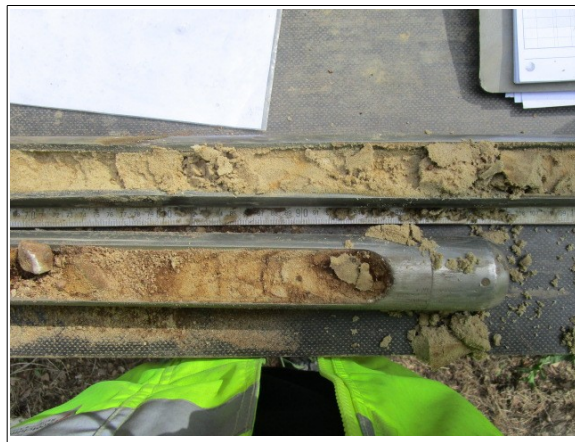
Abbildung 20: Fahrbahn rechts Sand unterhalb der Auffüllung
