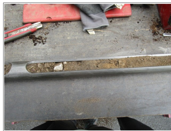
Abbildung 66: Bankett links Auffüllungsboden
