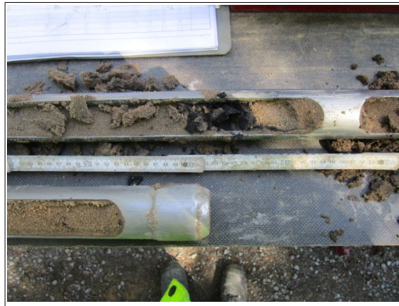
Abbildung 32: Fahrbahn links Unterhalb der Auffüllung Sand bis 1,3m
