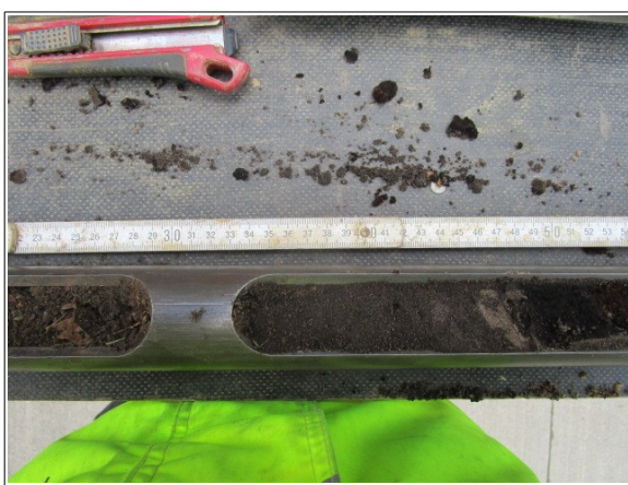
Abbildung 5: Bankett links Humose Deckschicht bis 0,3m darunter Auffüllung bis 0,6m
