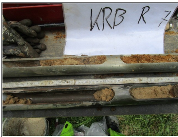
Abbildung 25: Radweg Sandschicht bis in 3m Tiefe
