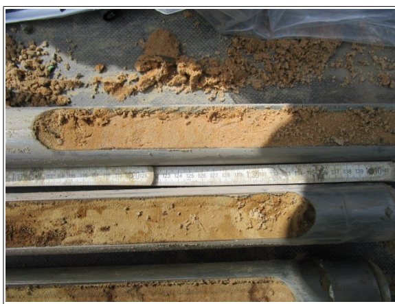
Abbildung 3: Fahrbahn links Unterhalb der Auffüllung Sande
