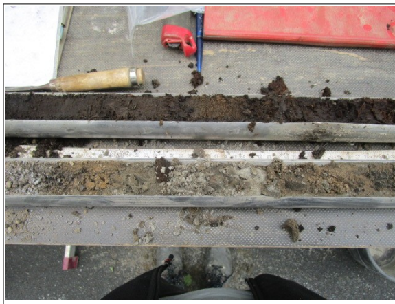
Abbildung 49: Fahrbahn links Auffüllungsboden mit Beton- und Ziegelbruch
