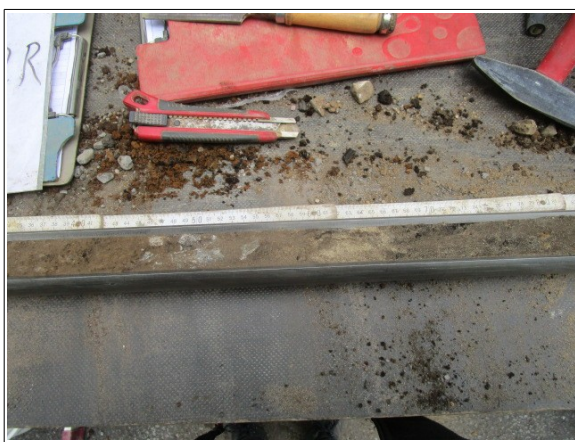
Abbildung 65: Bankett rechts Auffüllungsboden mit Betonbruchstücken
