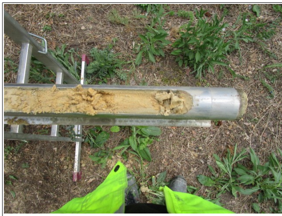
Abbildung 19: Fahrbahn rechts Auffüllungsboden bis 0,7m Tiefe
