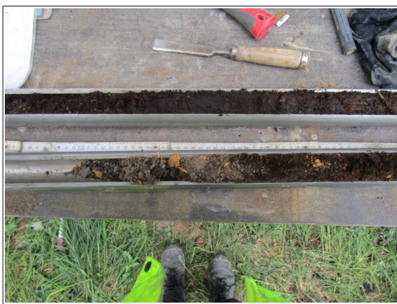
Abbildung 41: Radweg Sandschicht bis 0,7m
