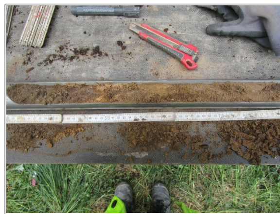
Abbildung 40: Bankett rechts Sandschicht
