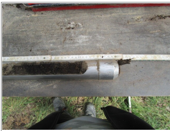
Abbildung 59: Bankett rechts Torfschicht
