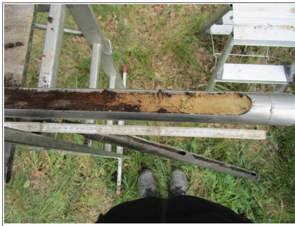
Abbildung 57: Radweg Übergang vom Torf- in die Sandschicht
