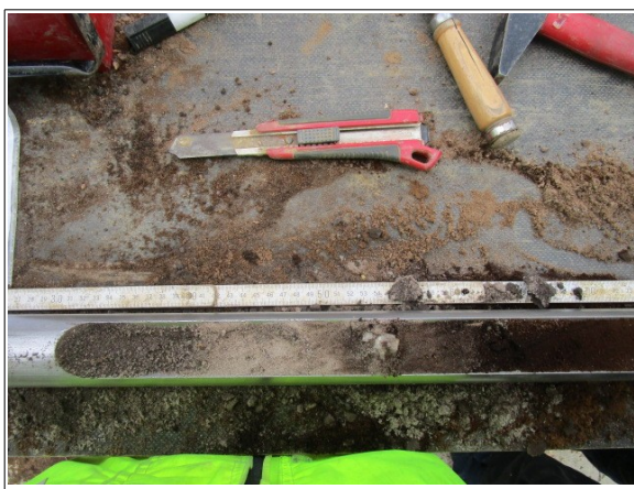
Abbildung 17: Bankett rechts Auffüllungsboden mit Betonbruchstücken
