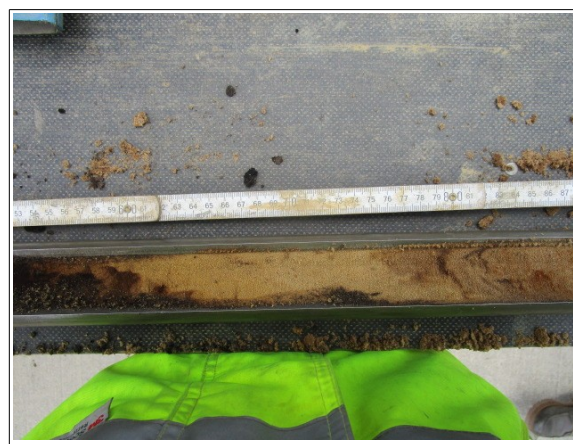
Abbildung 6: Bankett links Sandschicht unterhalb der Auffüllung
