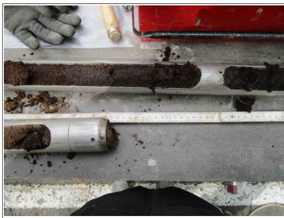
Abbildung 44: Radweg Torfschicht
