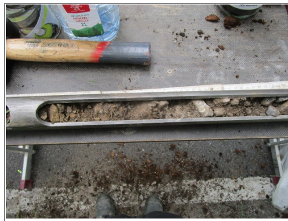
Abbildung 47: Bankett rechts Auffüllungsboden mit Betonbruchstücken
