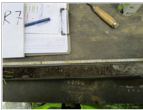
Abbildung 29: Bankett rechts Auffüllungsboden mit Betonbruchstücken
