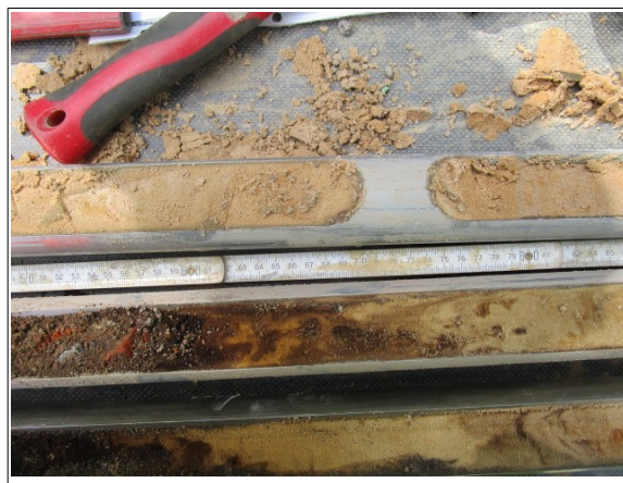
Abbildung 2: Fahrbahn links Auffüllungsboden mit Beton- und Ziegelbruch bis 0,6m
