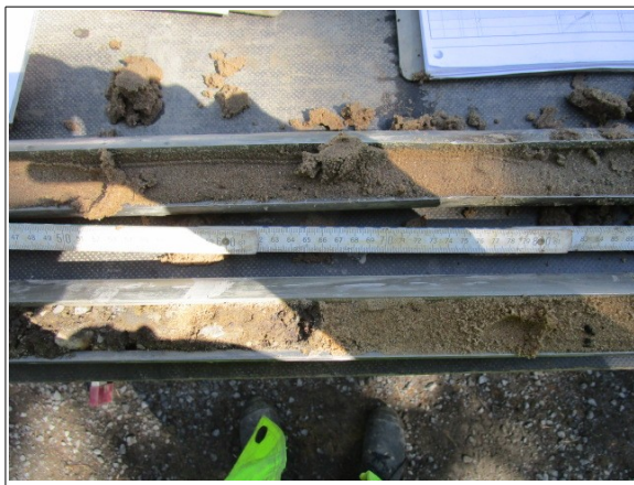
Abbildung 31: Fahrbahn links Auffüllungsboden bis 0,65m Tiefe
