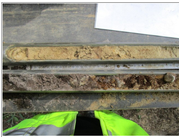
Abbildung 19: Fahrbahn rechts Auffüllungsboden bis 0,7m Tiefe
