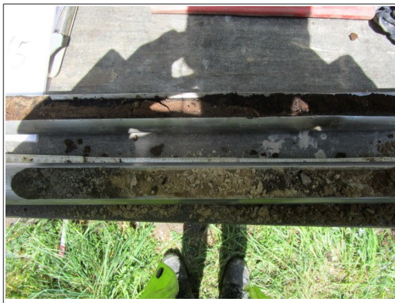
Abbildung 37: Fahrbahn links Auffüllungsboden bis 1m Tiefe
