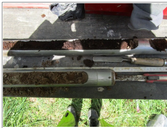
Abbildung 38: Fahrbahn links Unterhalb der Auffüllung Sandschicht bis 1,7m
