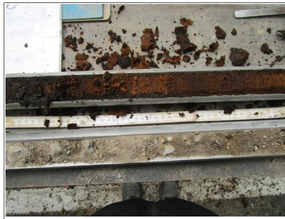
Abbildung 46: Fahrbahn rechts Auffüllungsboden bis in 1m Tiefe
