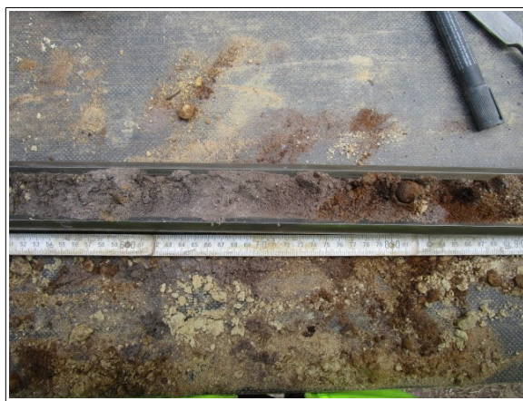
Abbildung 23: Bankett rechts Unterhalb der Deckschicht Auffüllungsboden
