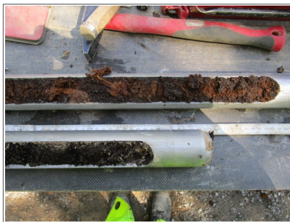
Abbildung 35: Radweg Unterhalb der Sandschicht Torf
