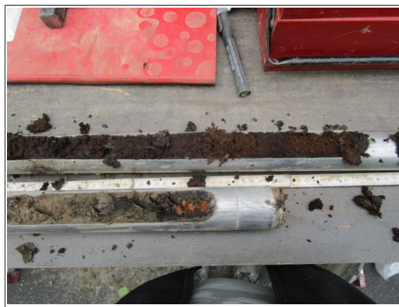
Abbildung 50: Fahrbahn links Unterhalb der Auffüllung Torf
