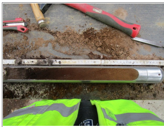
Abbildung 18: Bankett rechts Unterhalb der Auffüllung Sand
