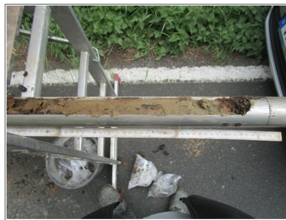
Abbildung 52: Radweg Sandschicht unterhalb des Torfes
