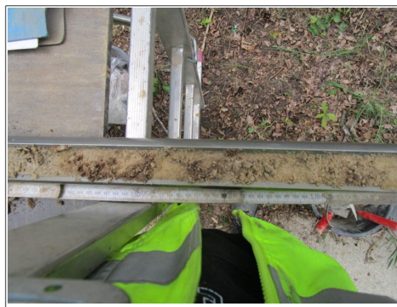
Abbildung 14: Fahrbahn links Unterhalb der Auffüllung Sand
