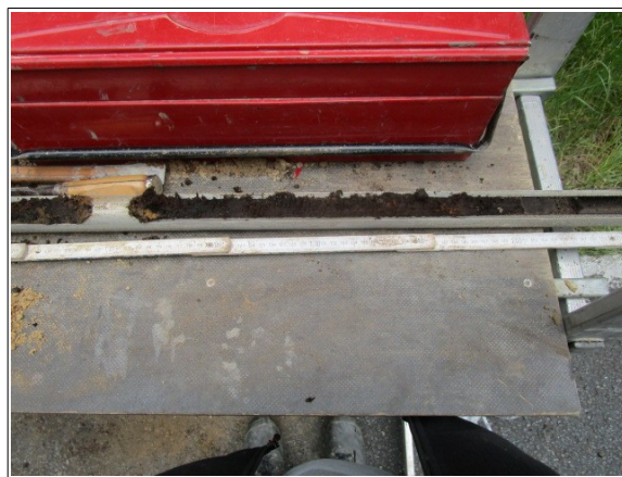
Abbildung 62: Fahrbahn links Unterhalb der Auffüllung Torf
