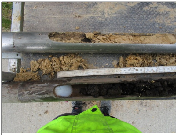
Abbildung 7: Fahrbahn rechts Auffüllung bis ca. 0,5m Tiefe
