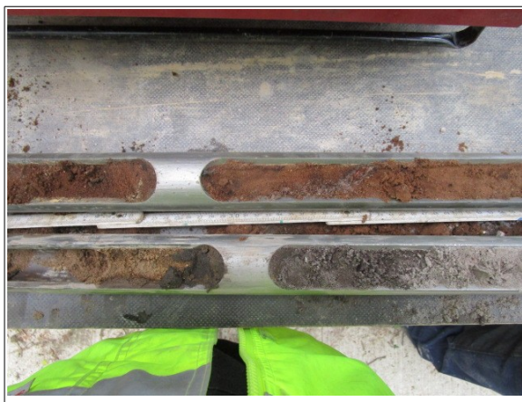
Abbildung 13: Fahrbahn links Auffüllungsboden bis in 1m Tiefe
