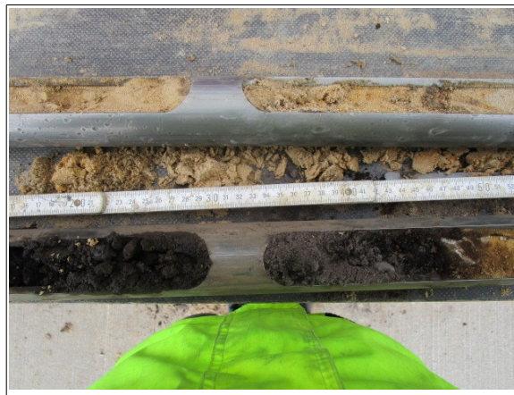
Abbildung 8: Fahrbahn rechts Unterhalb der Auffüllung Sand
