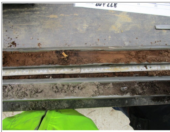
Abbildung 14: Fahrbahn links Unterhalb der Auffüllung Sand
