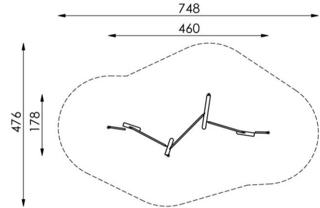
Gräserreck, bestehend Edelstahl-Standpfosten gebogen, farbig beschichtet, 3 Reckstangen aus Edelstahl in verschiedenen Höhen
