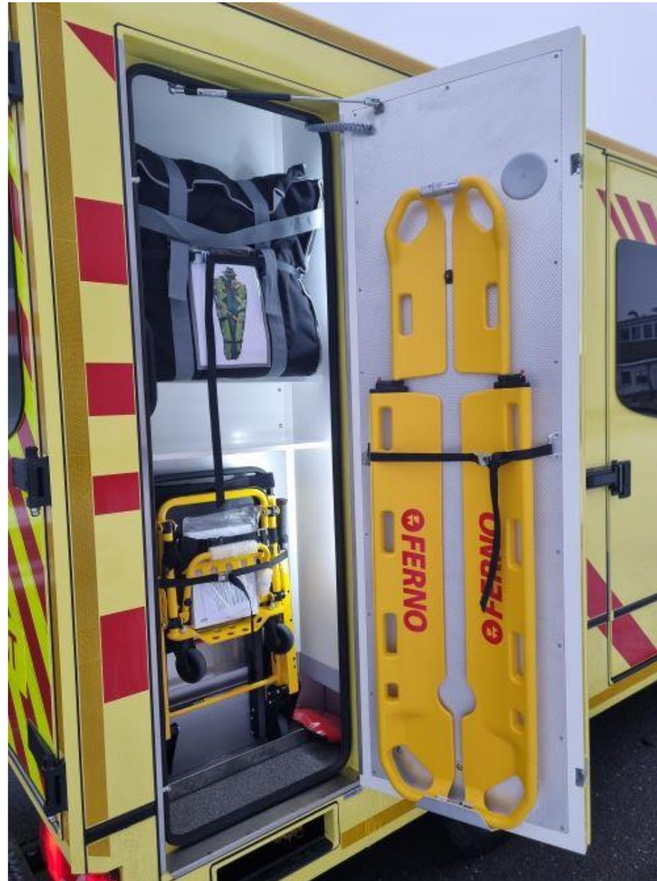
**24.4** Bild 4: Schrank 1 - Frontschrank, an der Rückwand Fahrerhaus unter der Arbeitsplatte Kofferschrank (Kindernotfallkoffer und Rucksack) hinter der Schiebetür, siehe 16.1
