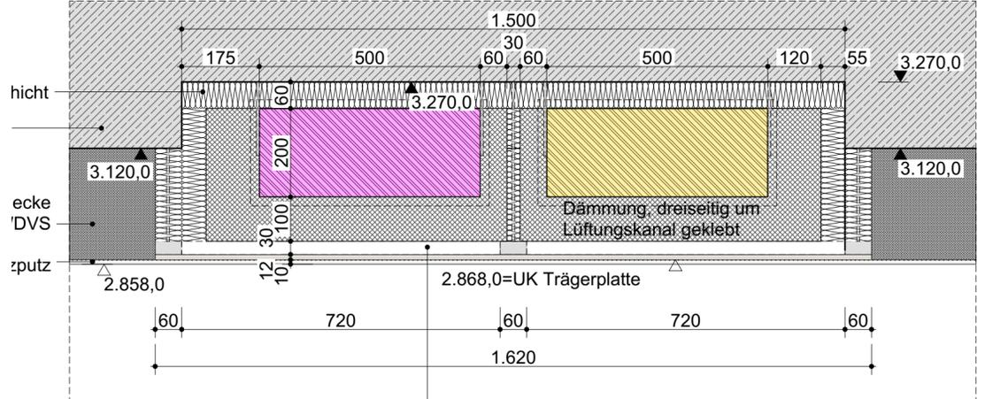
Ausführung der Unterkonstruktion aus verzinkten Stahlblechprofilen DIN 18182-1, als Grund- und Tragprofile CD 60/27, Niveaueausgleich, Befestigung mit Direktabhängern/ Draht mit Öse+ Ankerfix/ Kombihänger \*/ Nonius mit Nonius-Hänger-Unterteil/ Kombihänger \*, und bauaufsichtlich zugelassenen Befestigungsmitteln.
