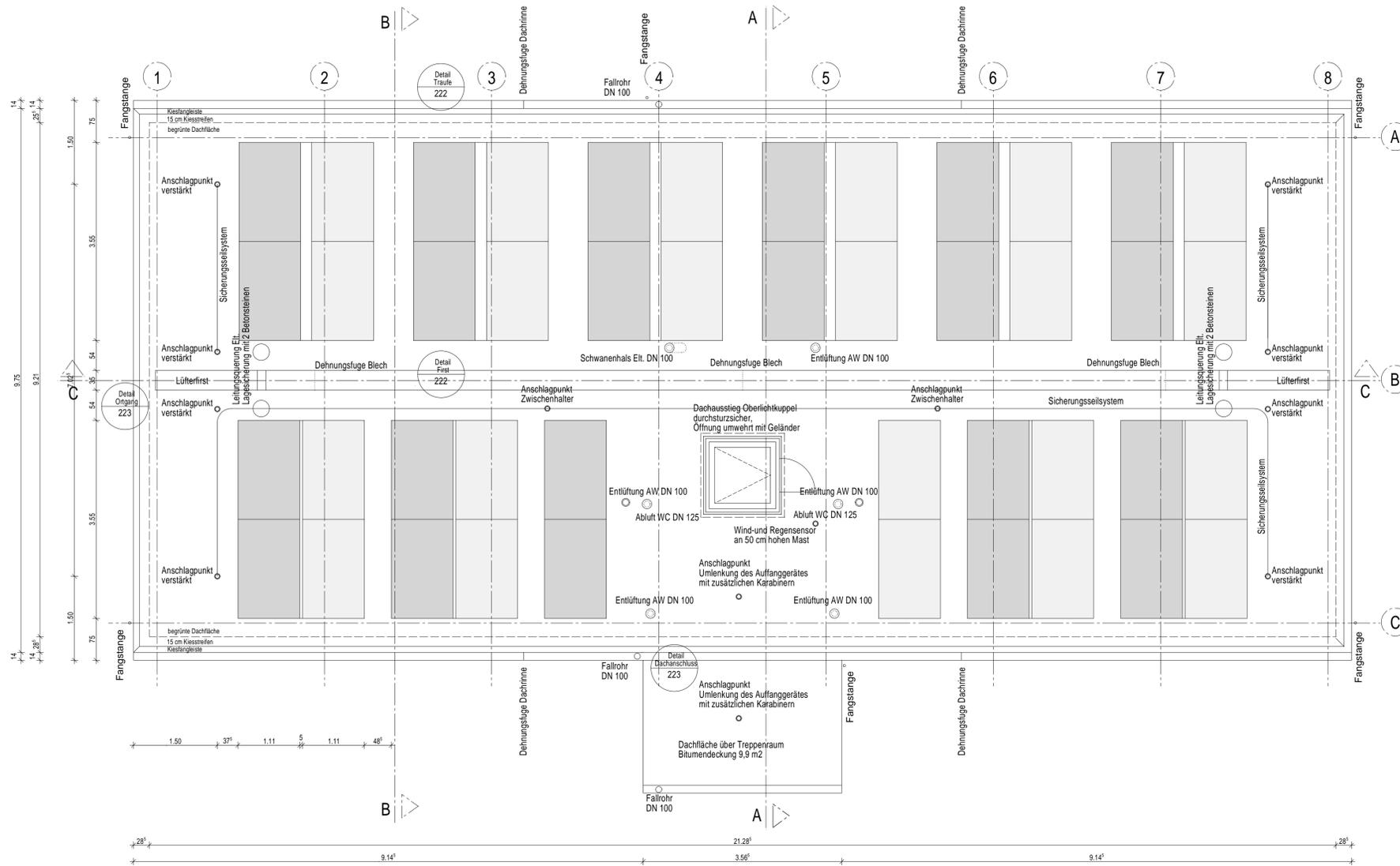
PV-Anlage mit Ost/Westausrichtung
