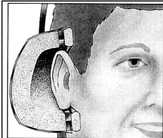
Aufbau eines Kapselgehörschützers mit Kopfbügel
