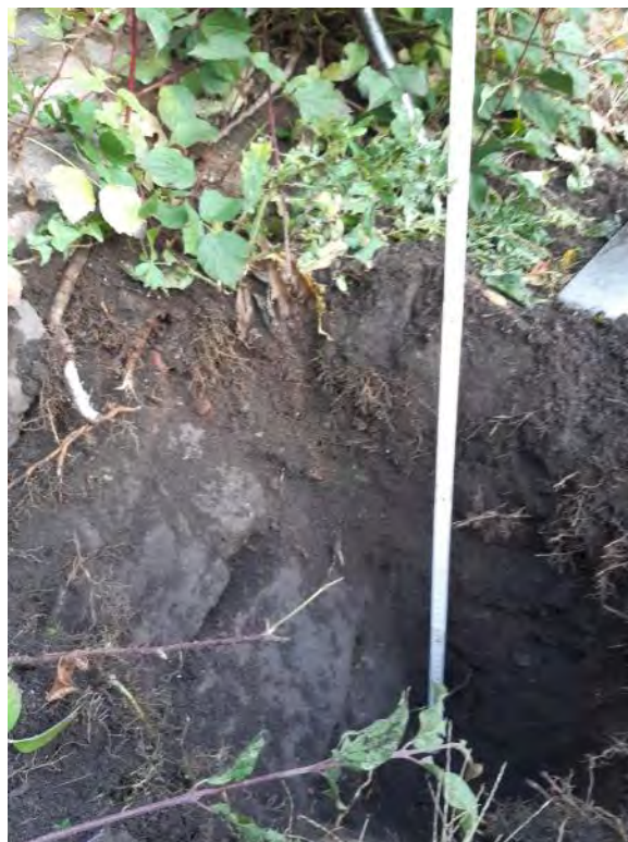
Foto 2: Detailfoto zum Schurf mit Granitsteinüberdeckung
