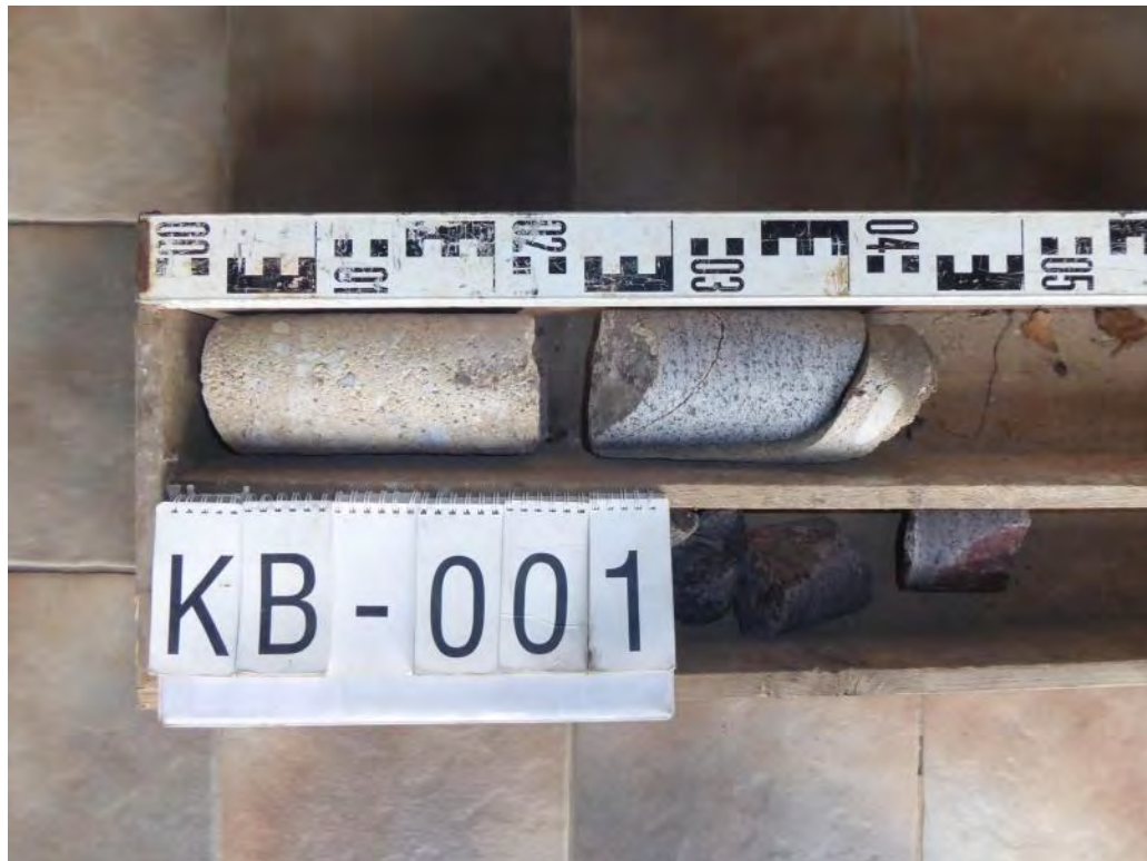
Foto 3: Bohrkern KB 1 (0,0...0,5 m)
