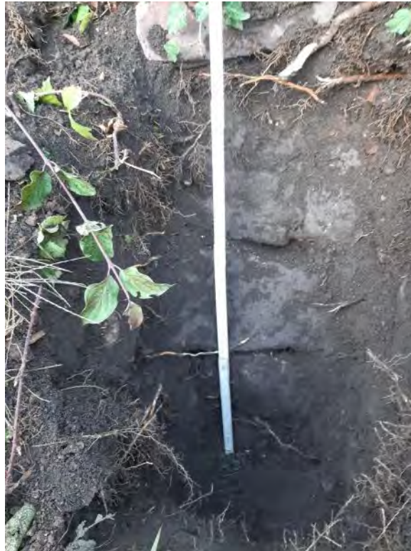
Foto 1: Schurf mit freigelegter Granitsteinüberdeckung
