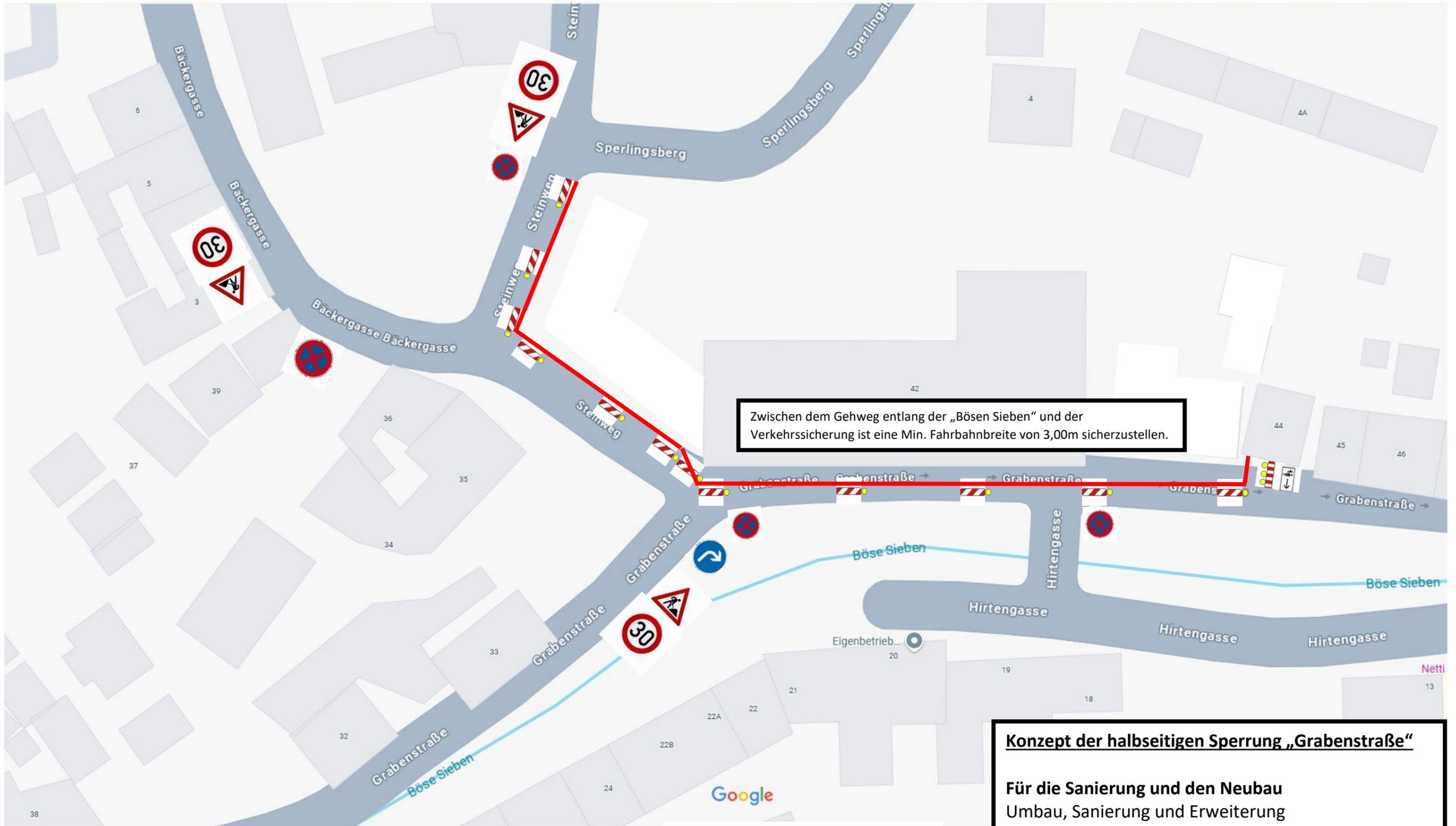
Zwischen dem Gehweg entlang der „Bösen Sieben“ und der Verkehrssicherung ist eine Min. Fahrbahnbreite von 3,00m sicherzustellen.
