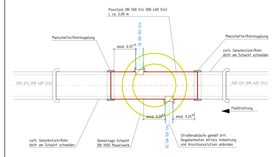
\*) Die Abstände zu Muffe/Spitzende oder untereinander müssen mindestens 250 mm betragen! Bei ausreichender Länge des Rohres dürfen maximal zwei Bohrungen je Rohr vorgenommen werden, der lichte Mindestabstand untereinander in Längs- und Querachse darf 250 mm nicht unterschreiten.
