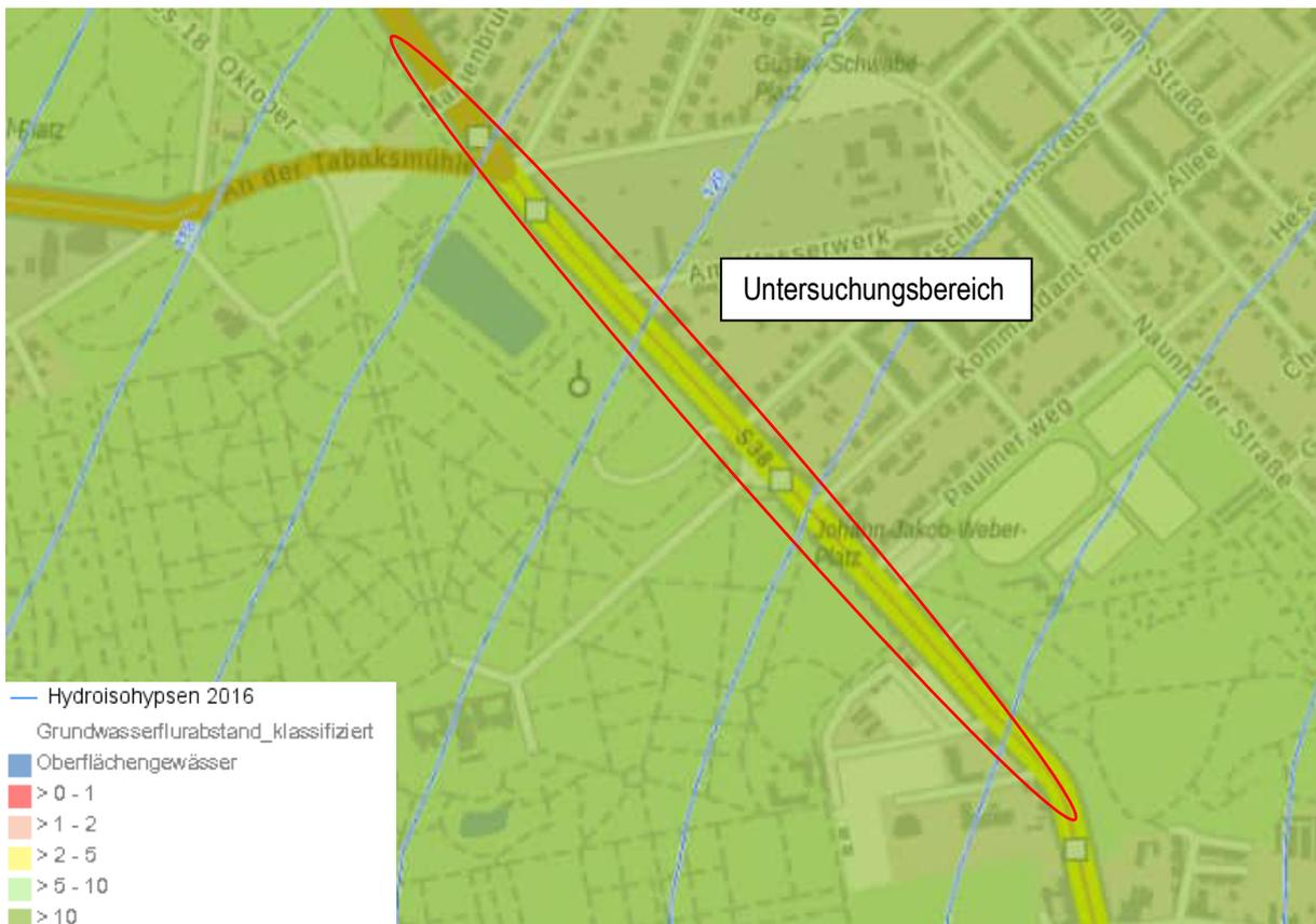
**Abbildung 3: Karte der Grundwasserdynamik [4]**
