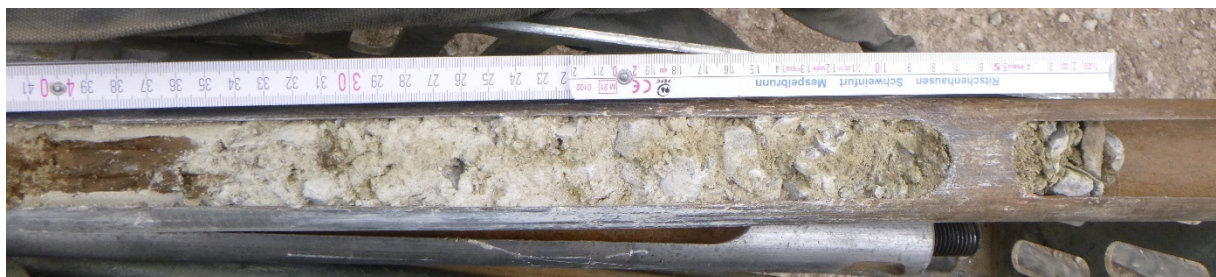
Bild 3: Schotter in der Bohrsonde der RKS 2
