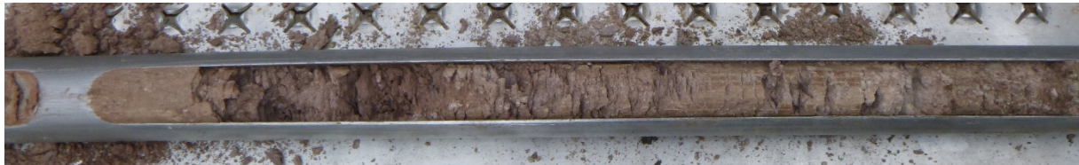
Bild 5: Violettgrauer Verwitterungsboden mit reliktscher Festgesteinsstruktur, RKS 5
