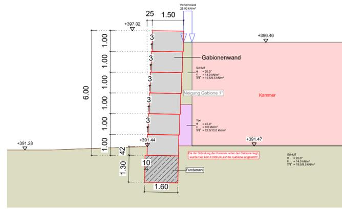
Schnitt A-A mit Kammer (M 1:100)
