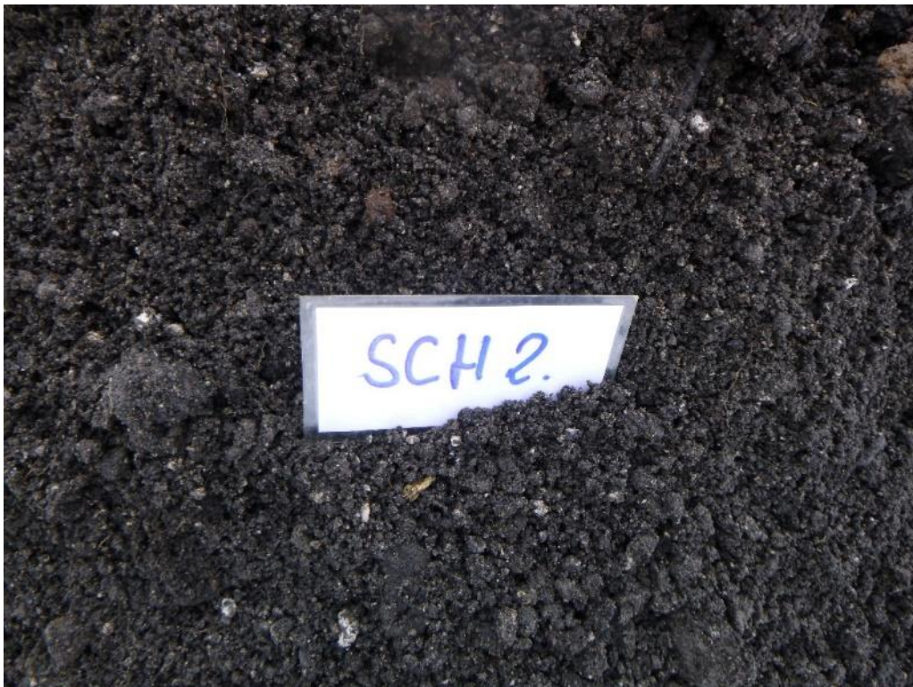
Bild 5: organischer Auffüllboden (Mudde), Schurf 2
