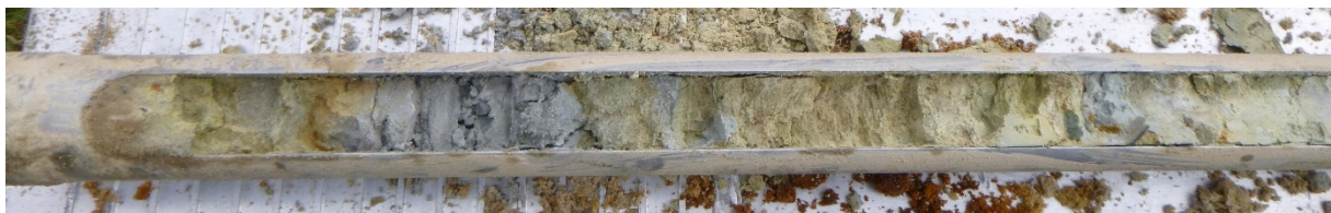
Bild 15: blättrig bis dickplattig abgesonderter Tonsiltstein, RKS 1
