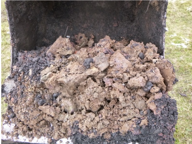
Bild 6: stark plastifizierter, lehmig-kiesiger Auffüllboden, Schurf 4
