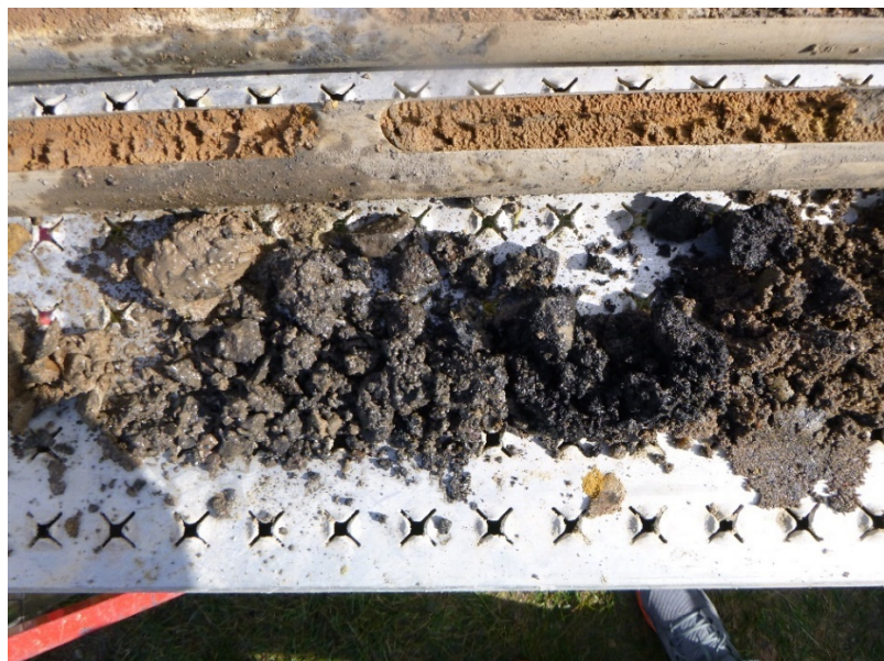
Bild 7: Auffüllung mit deutlichen Verfärbungen in der RKS 9
