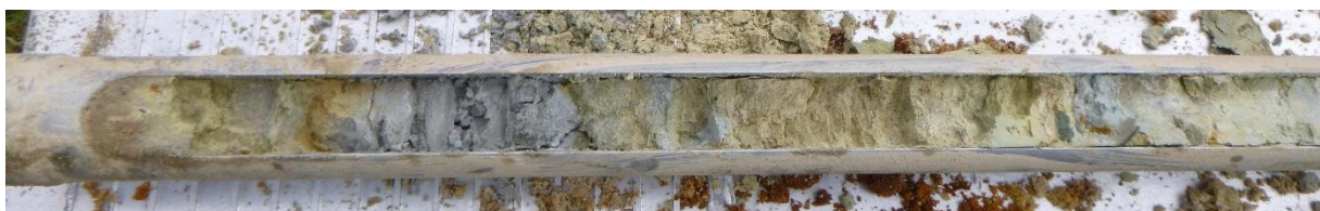
Bild 15: blättrig bis dickplattig abgesonderter Tonsiltstein, RKS 1
