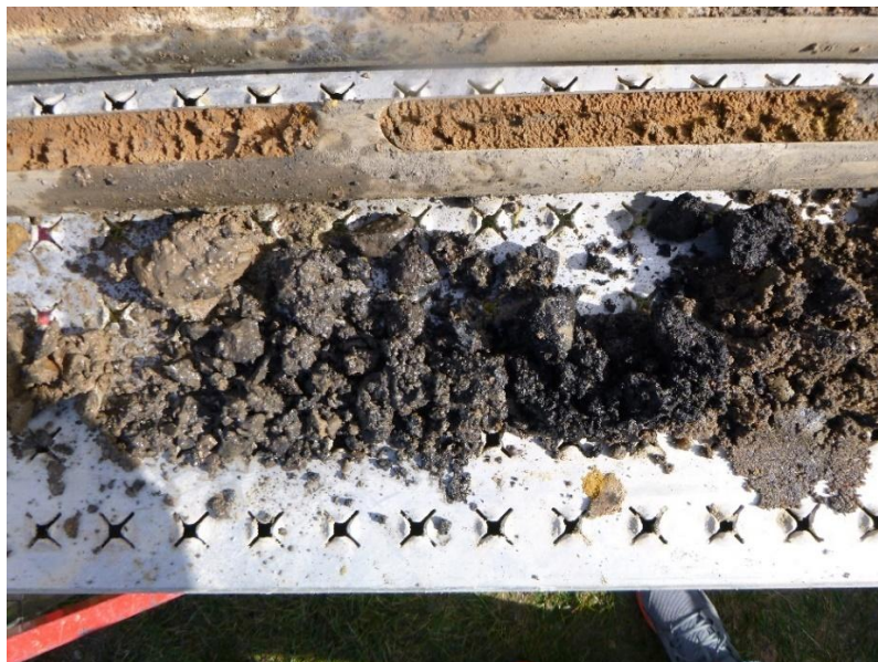
Bild 7: Auffüllung mit deutlichen Verfärbungen in der RKS 9
