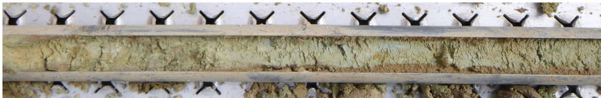
Bild 13: Verwitterungslehm des Tonsteins (RKS 1)
