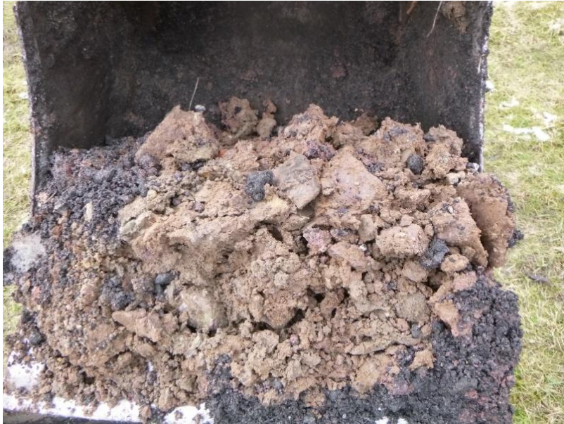
Bild 6: stark plastifizierter, lehmig-kiesiger Auffüllboden, Schurf 4
