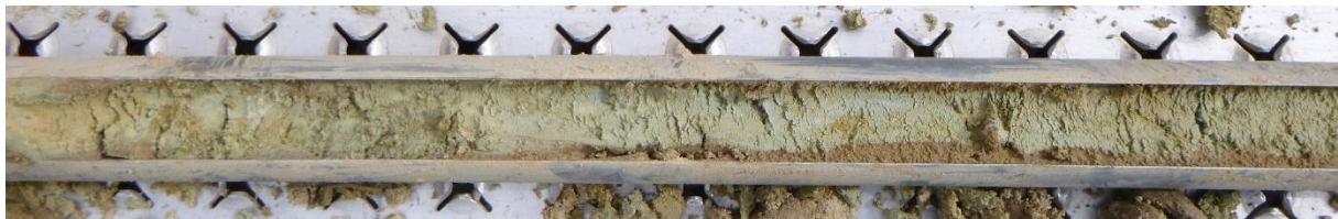
Bild 13: Verwitterungslehm des Tonsteins (RKS 1)
