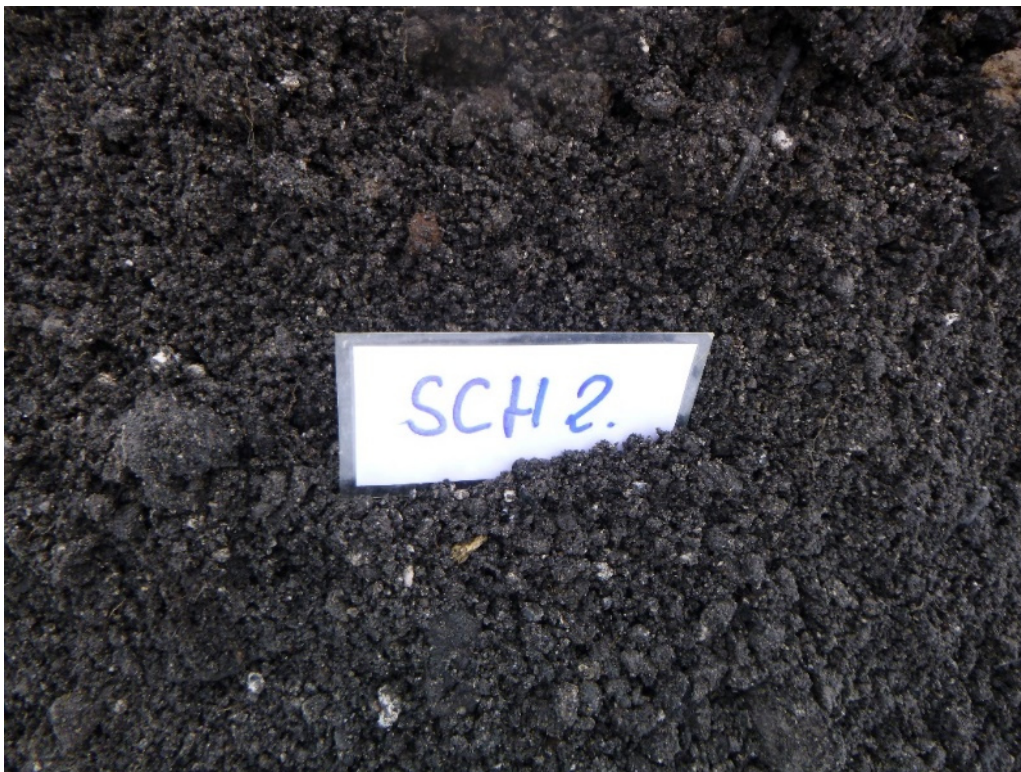
Bild 5: organischer Auffüllboden (Mudde), Schurf 2
