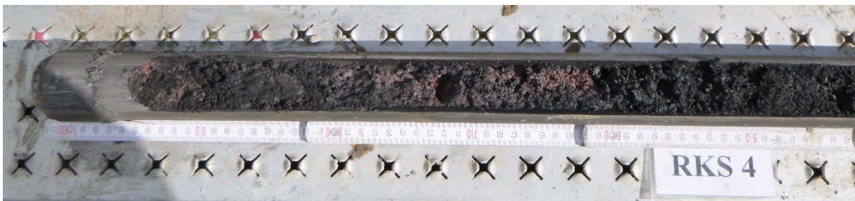
Bild 8: Auffüllung mit deutlichen Verfärbungen in der RKS 4
