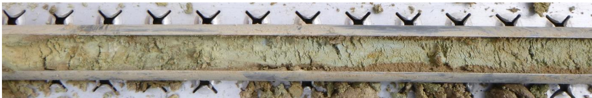
Bild 13: Verwitterungslehm des Tonsteins (RKS 1)
