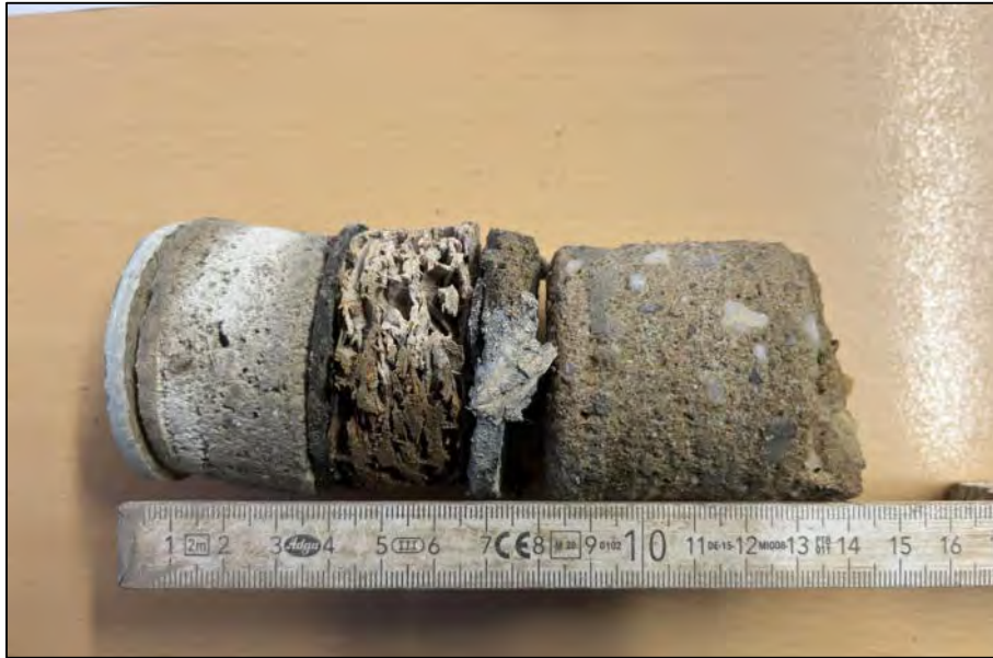
Abbildung 5: Bohrkern der Kernbohrung im Fußboden der nördlichen Baracke. Erkundeter Aufbau bestehend aus PVC-Belag, Estrich, Sperrschicht mit zwischengeschalteter HWL-Dämmung und Beton.
