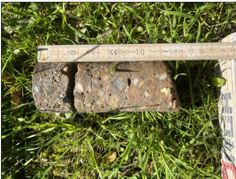
Abbildung 4: Bohrkern der Kernbohrung im Fußboden des Heizraumes (Schulgebäude). Erkundeter Aufbau bestehend aus Beton.
