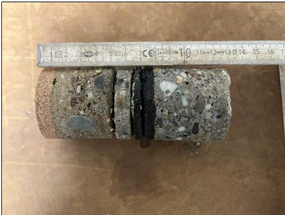
Abbildung 2: Bohrkern der Kernbohrung im Fußboden der Umkleide (Anbau Schulgebäude). Erkundeter Aufbau bestehend aus Fliese, Estrich, Sperrschicht und Beton.
