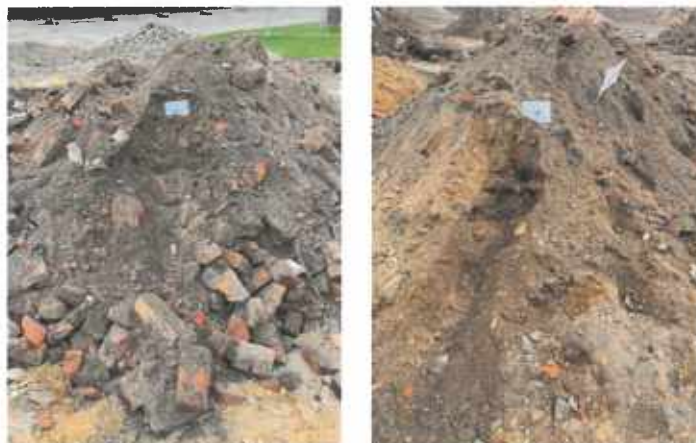
Abbildung 33 Entnahmestellen EP 17 und EP 18 aus Bodenaushub Schurf B-4
