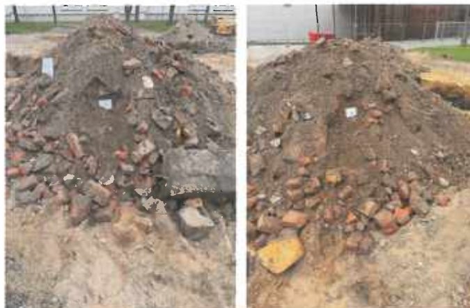
Abbildung 24 Entnahmestellen EP 11 und EP 12 aus Bodenaushub Schurf B-1
