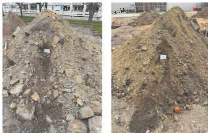
Abbildung 13 Entnahmestellen EP 5 und EP 6 aus Bodenaushub Schurf A-3
