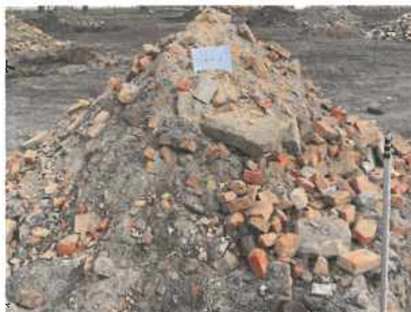
Abbildung 29 Bodenaushub aus Schurf B-3
