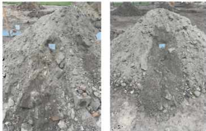
Abbildung 10 Entnahmestellen EP 3 und EP 4 aus Bodenaushub Schurf A-2
