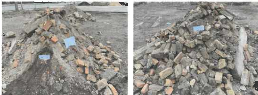
Abbildung 68 Entnahmestellen EP 37 und EP 38 aus Bodenaushub Schurf D-3
