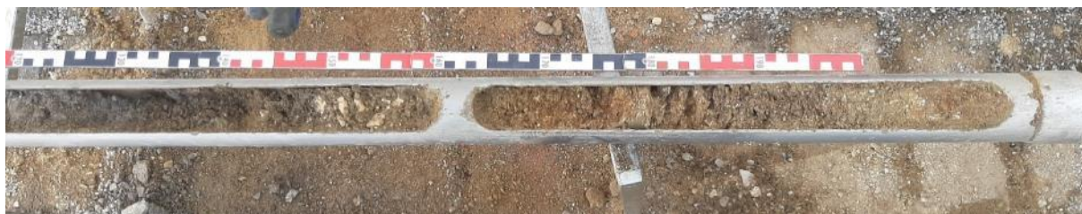
Abbildung 3: Bohrkern KRB 36/23. Entnahmetiefe 1,0 – 3,2 m unter GOK.
