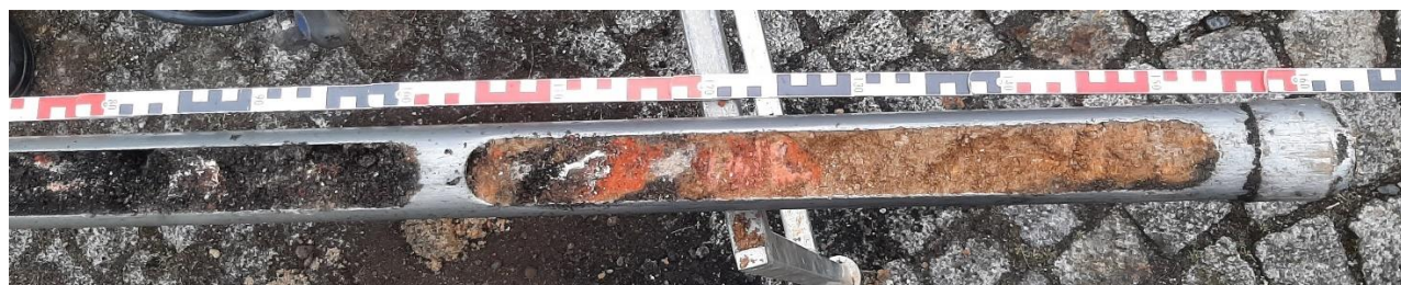
Abbildung 3: Bohrkern KRB 20/23. Entnahmetiefe 1,0 – 3,6 m unter GOK.
