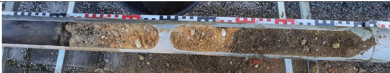
Abbildung 2: Bohrkern KRB 46/23. Entnahmetiefe 0,0 – 1,0 m unter GOK.
