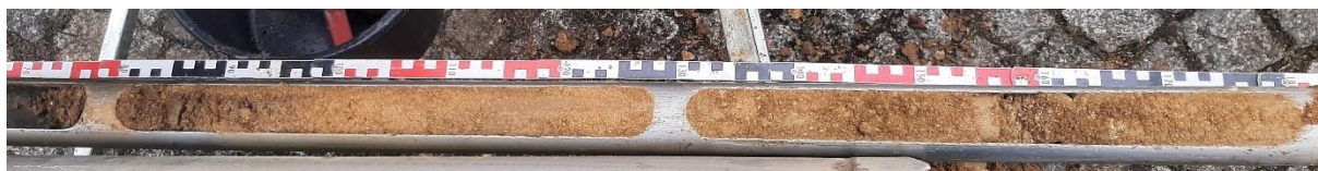
Abbildung 3: Bohrkern KRB 24/23. Entnahmetiefe 1,0 – 2,85 m unter GOK.
