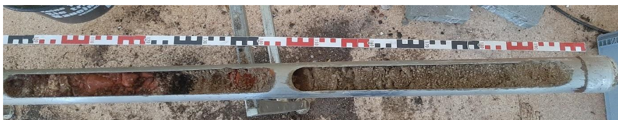
Abbildung 3: Bohrkern KRB 19/23. Entnahmetiefe 3,0 – 4,0 m unter GOK.
