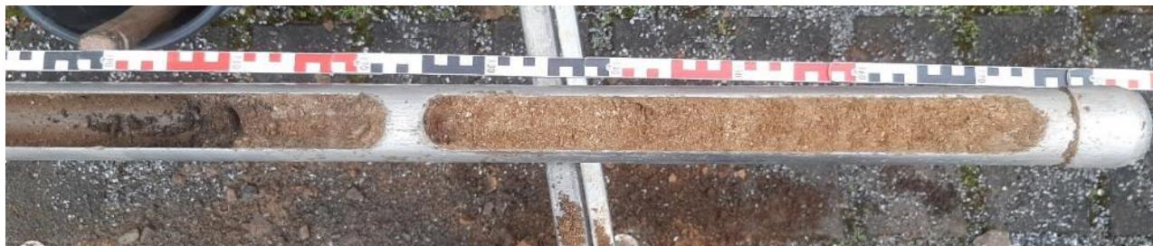
Abbildung 3: Bohrkern KRB 35/23. Entnahmetiefe 1,0 – 2,8 m unter GOK.
