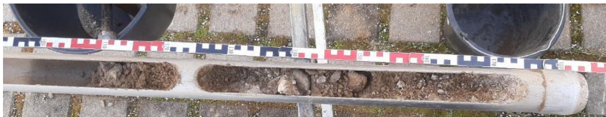
Abbildung 3: Bohrkern KRB 37/23. Entnahmetiefe 1,0 – 1,8 m unter GOK.
