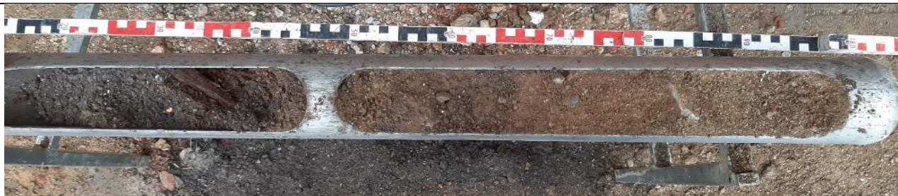
Abbildung 2: Bohrkern KRB 33/23. Entnahmetiefe 0,0 – 1,0 m unter GOK.
