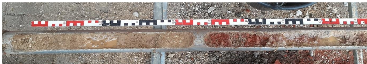
Abbildung 3: Bohrkern KRB 31/23. Entnahmetiefe 1,0 – 3,1 m unter GOK.
