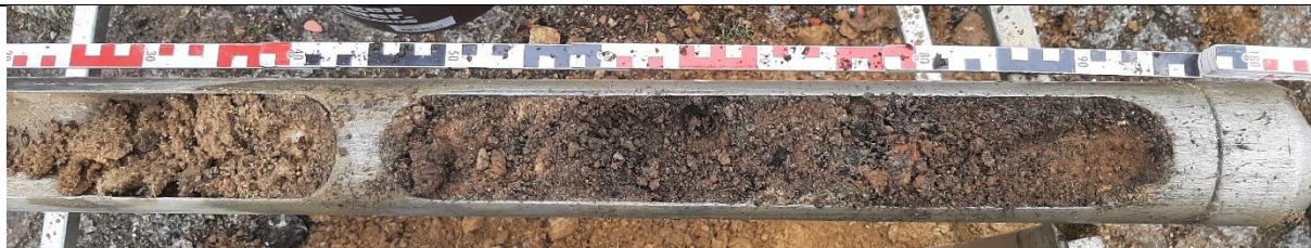
Abbildung 2: Bohrkern KRB 23/23. Entnahmetiefe 0,0 – 1,0 m unter GOK.
