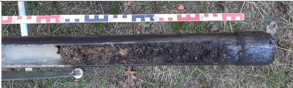
Abbildung 2: Bohrkern KRB 22/23. Entnahmetiefe 1,35 – 2,25 m unter GOK.
