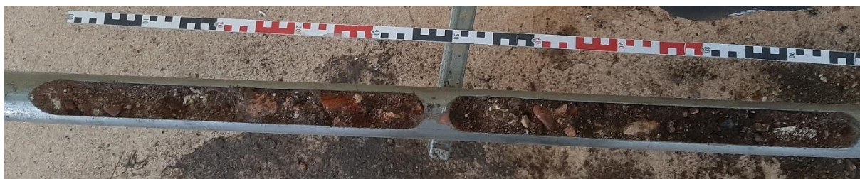
Abbildung 3: Bohrkern KRB 18/23. Entnahmetiefe 1,0 – 3,0 m unter GOK.
