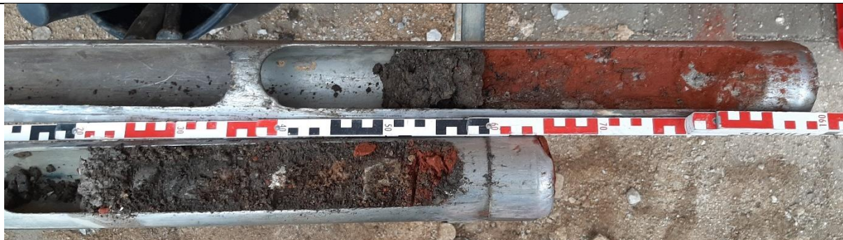
Abbildung 2: Bohrkern KRB 31/23. Entnahmetiefe 0,0 – 1,0 m unter GOK. (Im Ziegelmauerwerk doppelt angesetzt. Bohrmeter 1 befindet sich in 2 Sonden.)
