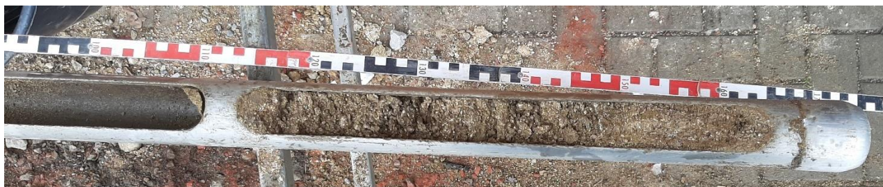
Abbildung 3: Bohrkern KRB 30/23. Entnahmetiefe 1,0 – 2,7 m unter GOK.
