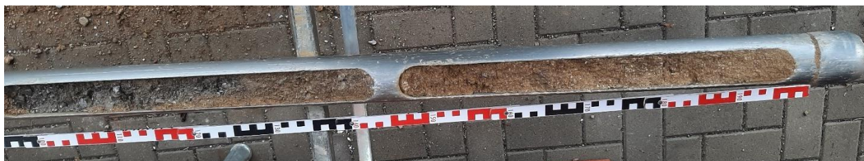
Abbildung 4: Bohrkern KRB 28/23. Entnahmetiefe 2,0 – 3,0 m unter GOK.
