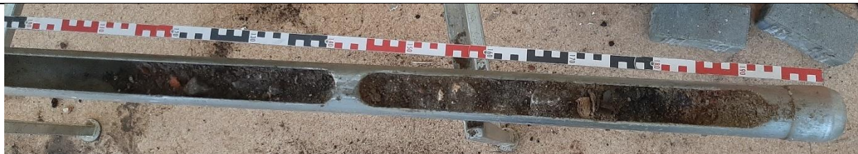
Abbildung 2: Bohrkern KRB 19/23. Entnahmetiefe 1,0 – 3,0 m unter GOK.
