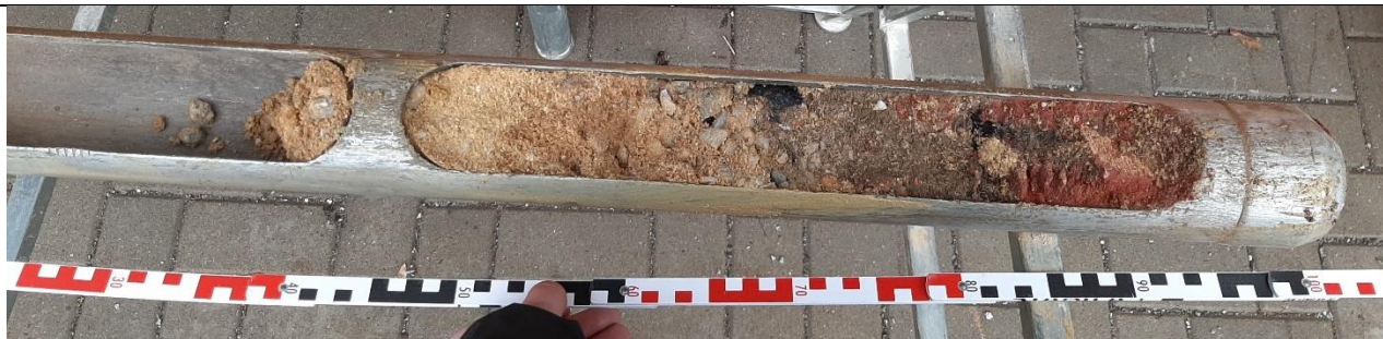
Abbildung 2: Bohrkern KRB 27/23. Entnahmetiefe 0,0 – 1,0 m unter GOK.
