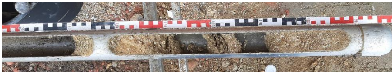
Abbildung 3: Bohrkern KRB 34/23. Entnahmetiefe 1,0 – 1,95 m unter GOK.
