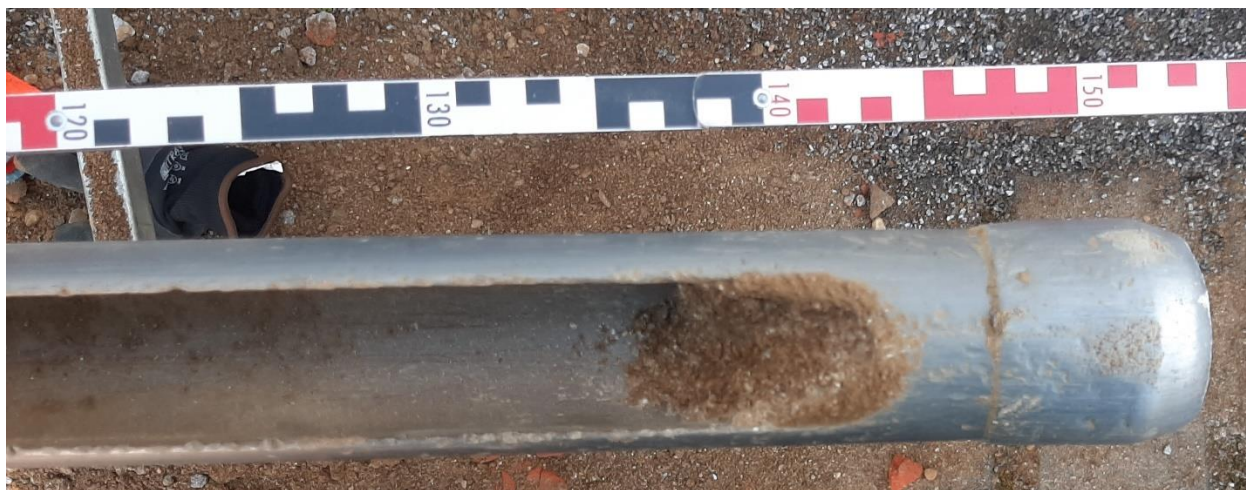
Abbildung 3: Bohrkern KRB 46/23. Entnahmetiefe 1,0 – 1,5 m unter GOK.
