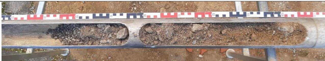
Abbildung 2: Bohrkern KRB 42/23. Entnahmetiefe 0,0 – 1,0 m unter GOK.
