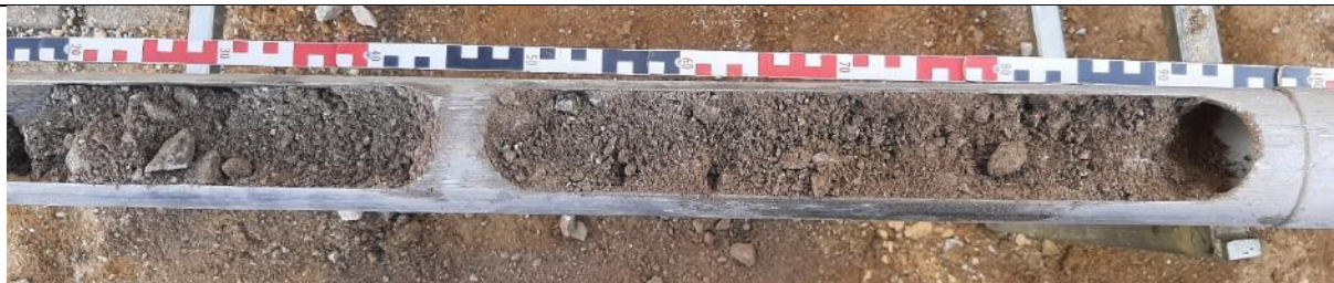
Abbildung 2: Bohrkern KRB 37/23. Entnahmetiefe 0,0 – 1,0 m unter GOK.
