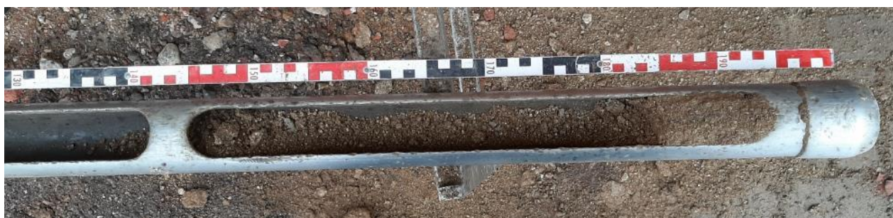
Abbildung 3: Bohrkern KRB 33/23. Entnahmetiefe 1,0 – 2,0 m unter GOK.
