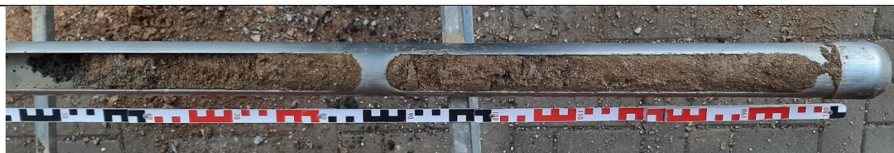
Abbildung 2: Bohrkern KRB 32/23. Entnahmetiefe 0,0 – 1,0 m unter GOK.
