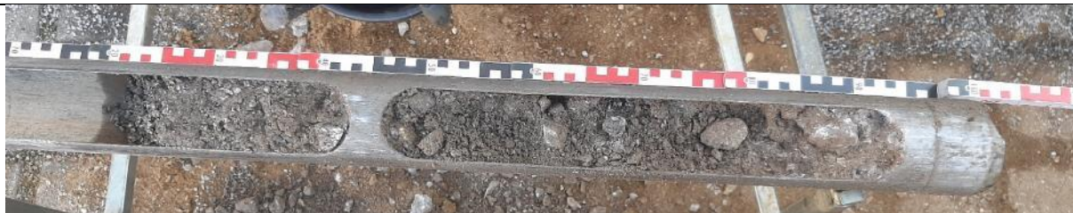
Abbildung 2: Bohrkern KRB 36/23. Entnahmetiefe 0,0 – 1,0 m unter GOK.
