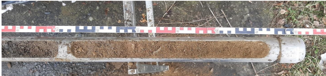
Abbildung 3: Bohrkern KRB 17/23. Entnahmetiefe 1,0 – 2,8 m unter GOK.
