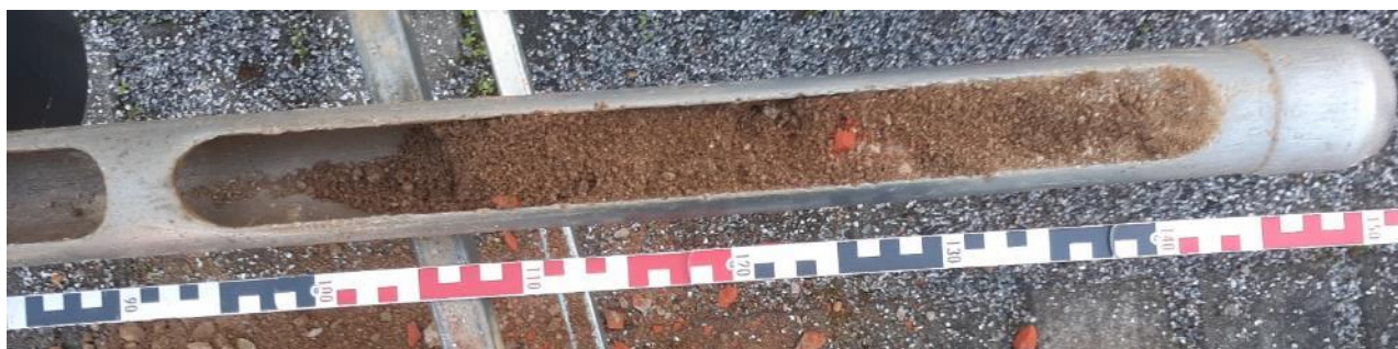
Abbildung 3: Bohrkern KRB 40/23. Entnahmetiefe 1,0 – 1,5 m unter GOK.
