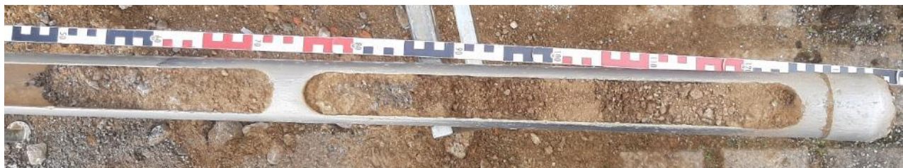
Abbildung 3: Bohrkern KRB 41/23. Entnahmetiefe 1,0 – 2,3 m unter GOK.
