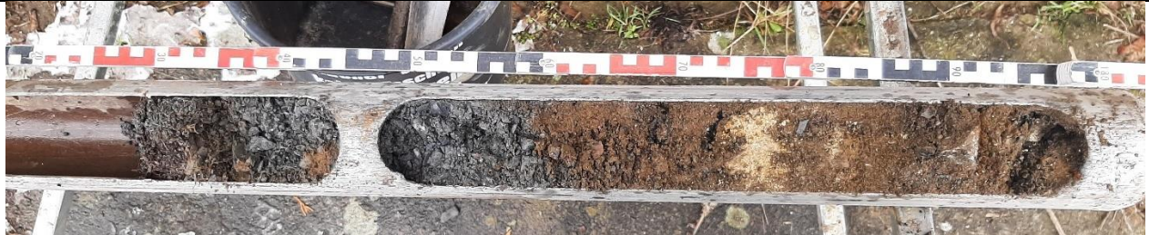
Abbildung 2: Bohrkern KRB 17/23. Entnahmetiefe 0,0 – 1,0 m unter GOK.
