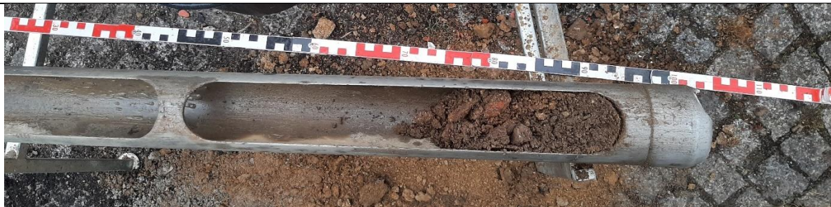
Abbildung 2: Bohrkern KRB 24/23. Entnahmetiefe 0,0 – 1,0 m unter GOK.
