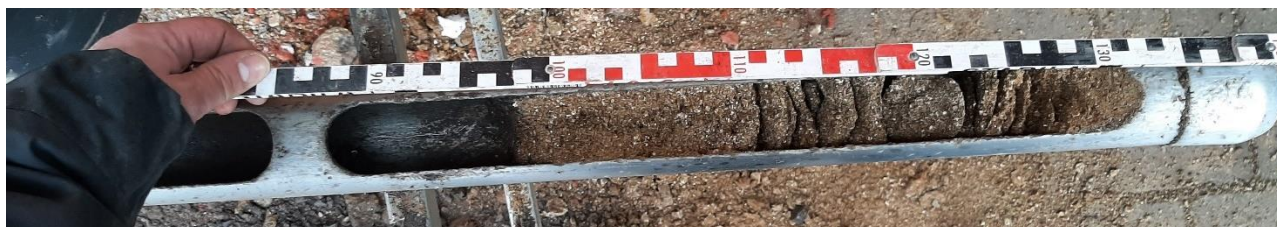
Abbildung 3: Bohrkern KRB 44/23. Entnahmetiefe 1,0 – 2,4 m unter GOK.
