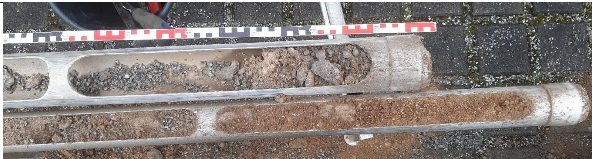
Abbildung 2: Bohrkerne KRB 21/23. Entnahmetiefe 0,0 – 2,4 m unter GOK.
