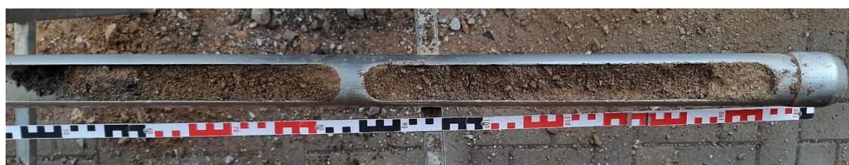
Abbildung 3: Bohrkern KRB 32/23. Entnahmetiefe 1,0 – 2,4 m unter GOK.
