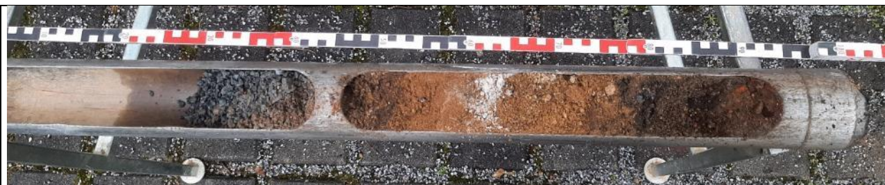
Abbildung 2: Bohrkern KRB 35/23. Entnahmetiefe 0,0 – 1,0 m unter GOK.
