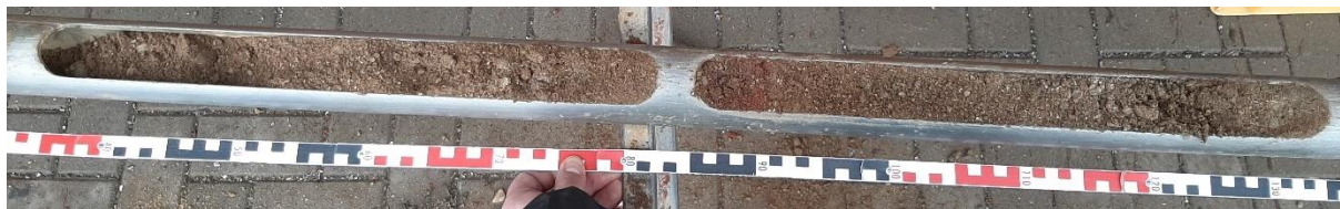
Abbildung 3: Bohrkern KRB 27/23. Entnahmetiefe 1,0 – 2,4 m unter GOK.
