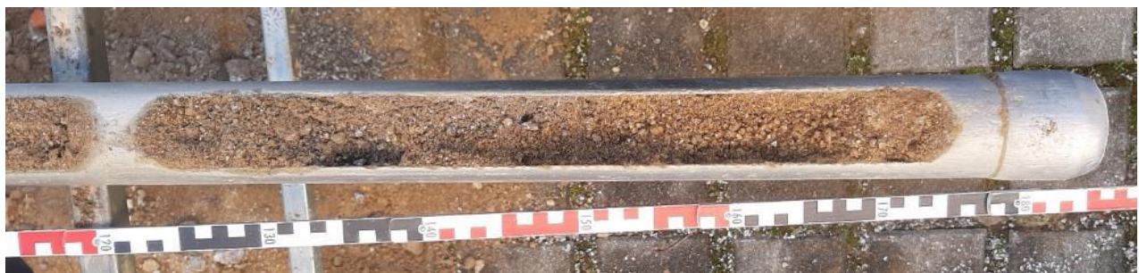
Abbildung 3: Bohrkern KRB 42/23. Entnahmetiefe 1,0 – 1,8 m unter GOK.
