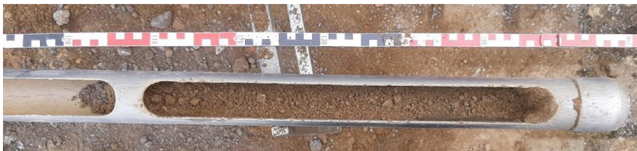
Abbildung 3: Bohrkern KRB 38/23. Entnahmetiefe 1,0 – 1,6 m unter GOK.
