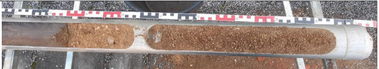
Abbildung 2: Bohrkern KRB 39/23. Entnahmetiefe 0,0 – 2,0 m unter GOK.
