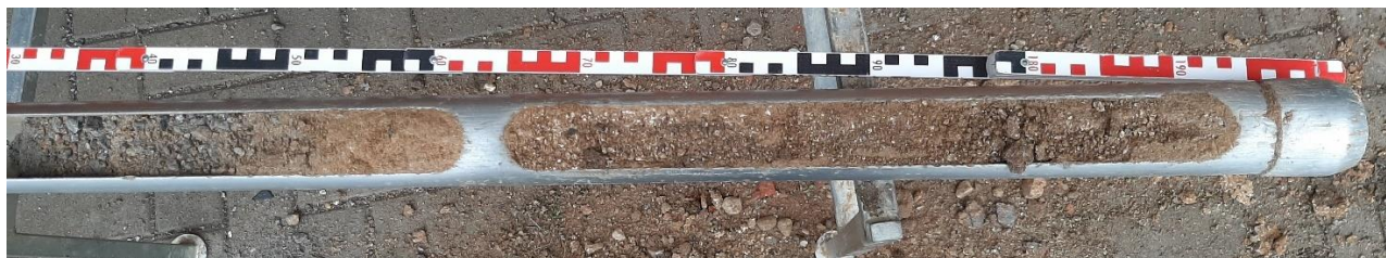
Abbildung 3: Bohrkern KRB 29/23. Entnahmetiefe 1,0 – 3,0 m unter GOK.
