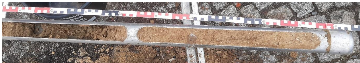
Abbildung 3: Bohrkern KRB 26/23. Entnahmetiefe 1,0 – 3,6 m unter GOK.
