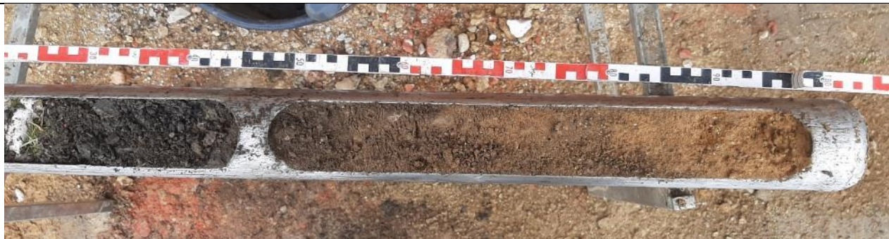
Abbildung 2: Bohrkern KRB 34/23. Entnahmetiefe 0,0 – 1,0 m unter GOK.
