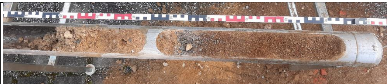
Abbildung 2: Bohrkern KRB 43/23. Entnahmetiefe 0,0 – 1,0 m unter GOK.
