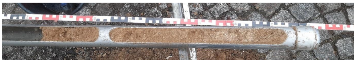
Abbildung 3: Bohrkern KRB 25/23. Entnahmetiefe 1,0 – 2,8 m unter GOK.
