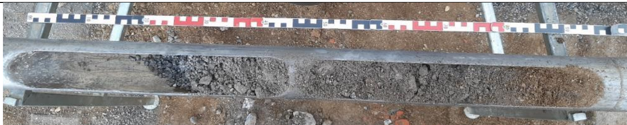
Abbildung 2: Bohrkern KRB 41/23. Entnahmetiefe 0,0 – 1,0 m unter GOK.
