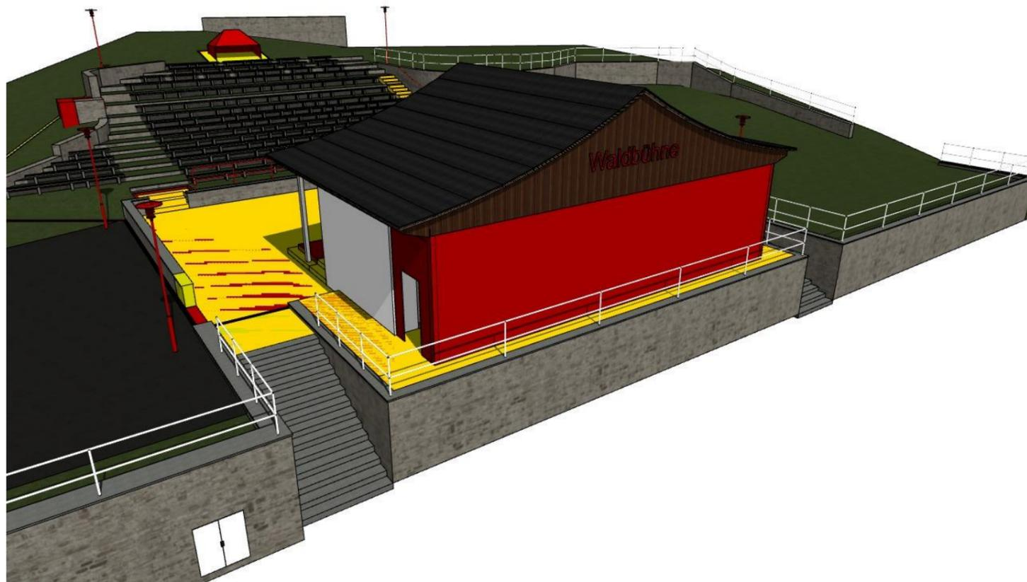
Überarbeitung Bühnenbereich mit neuen Belag auf und um der Bühne, Vergrößerung der Maueröffnungen, neue Rampen links und rechts zur Bühne, Mobile Vorhänge für Abschottung Backstagebereich mit möglicher Werbefläche
