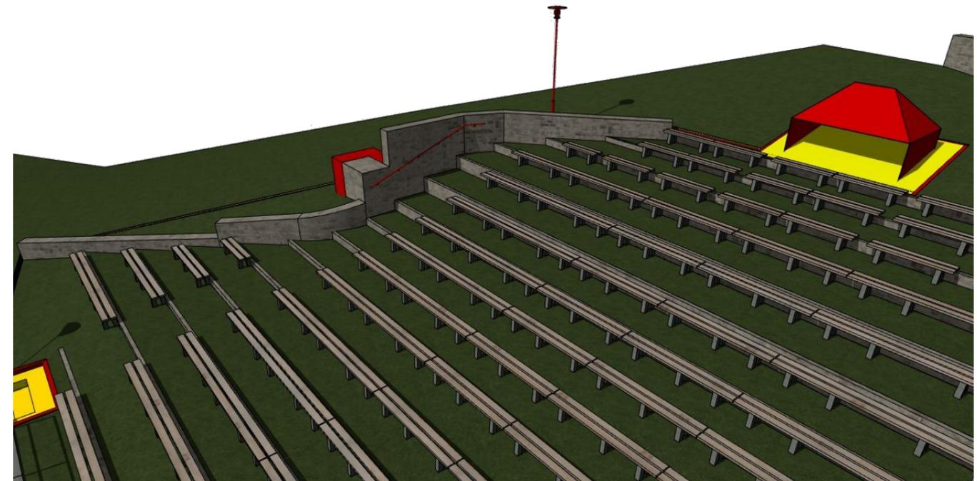
Überarbeitung Zuschauerbereich mit neuen Geländer mit indirekter Beleuchtung, Plateau für Bühnentechnik mit neuer Elektrounterverteilung, neue Laternenbeleuchtung, neue Aufstellfläche für Spotlight
