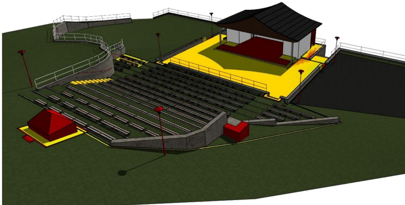
neue Treppenanlage Bühnenbereich mit integrierten Rampen, neue Treppenanlage vom Vorplatzbühne zum Zuschauerbereich, neues Geländer/Absturzsicherung vom Vorplatzbühne zum Zuschauerbereich, neue Treppenanlage im Zuschauerbereich, neue Aufstellfläche für Spotligh, neues Plateau für Bühnentechnik mit neuen Elektrounterverteilung und neuen Kabelkanal von Plateau zur Bühne, neue Laterenbeleuchtung
