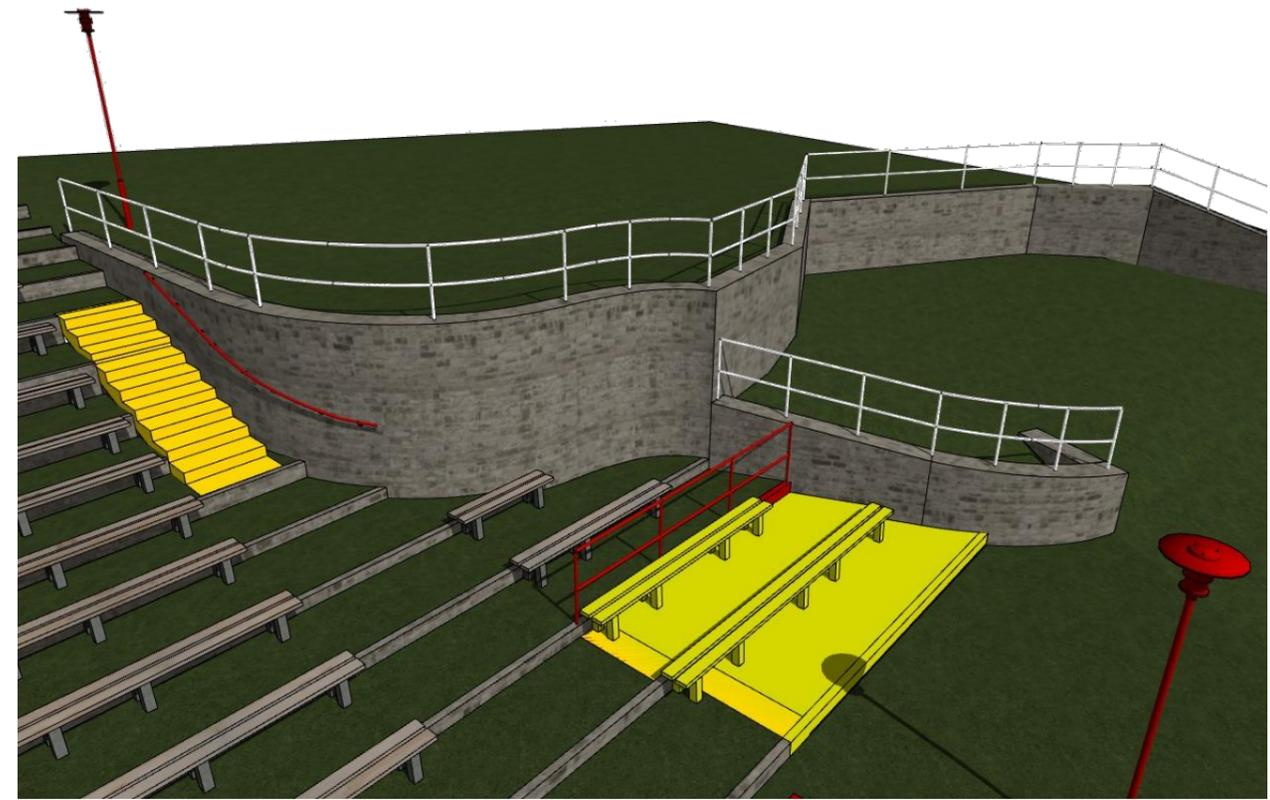
Abbruch und Neubau Treppenanlage sowie Geländer mit indirekter Beleuchtung Stellflächen Rollstühle
