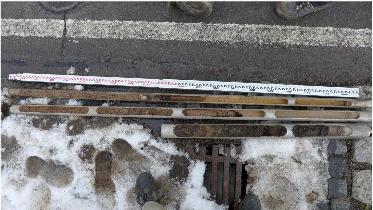
Bild 1: Bohrung BS 1/20, Tiefe: 4,90 m
