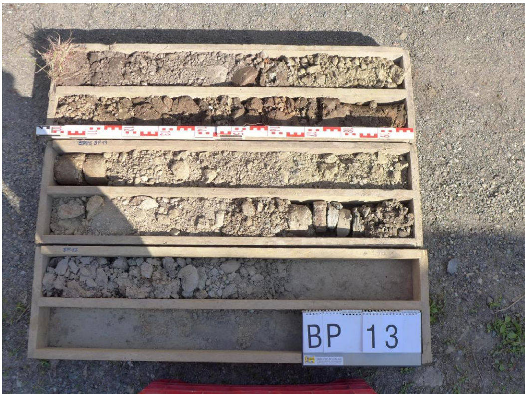
Regenrückhaltebecken RRB 1: Bohrung BP 8/2019
