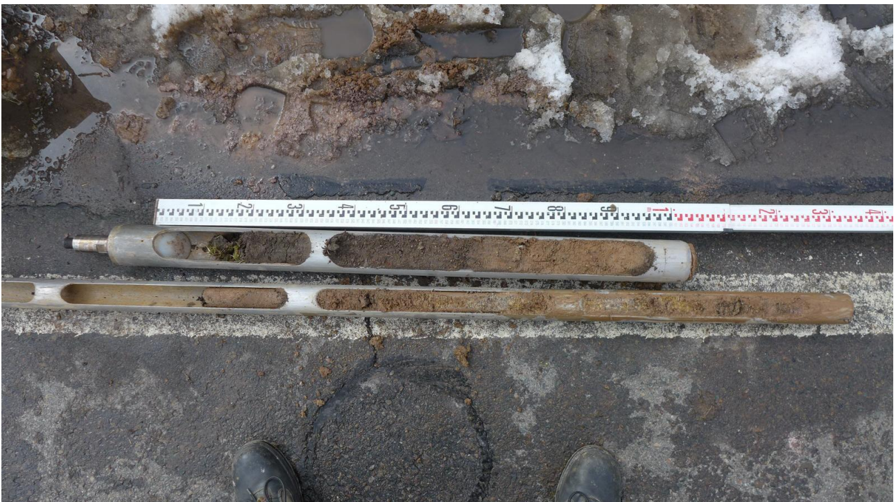
Bild 2: Bohrung BS2/20, Tiefe: 2,40 m
